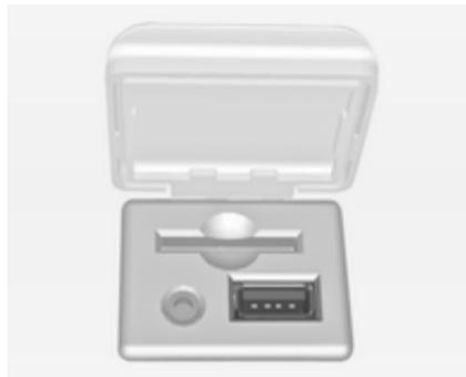
Vor dem Schalthebel in der Mittelkonsole befindet sich eine USB-Buchse, an die externe Audiodatenquellen angeschlossen werden können.
