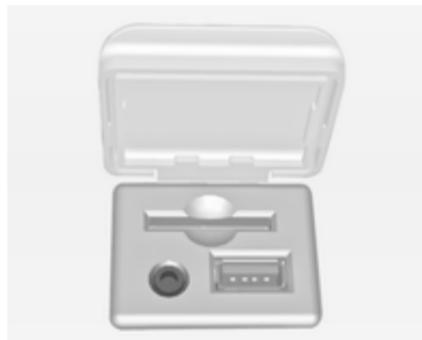
Vor dem Schalthebel in der Mittelkonsole befindet sich eine AUX-Buchse, an die externe Audioquellen angeschlossen werden können.
