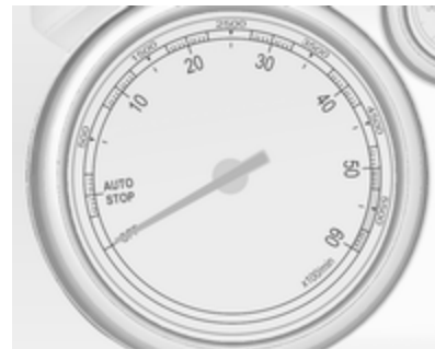
Zeigt die Motordrehzahl an.
