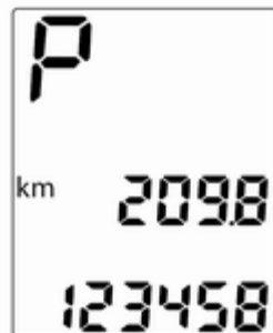
Anzeige der gezählten Kilometer in der unteren Zeile.
