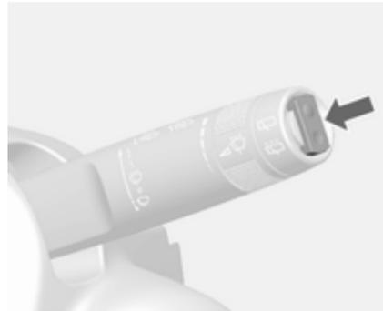
Zur Betätigung des Heckscheibenwischers Wippschalter drücken:
