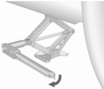
Radschlüssel ansetzen und den korrekt ausgerichteten Wagenheber hochkurbeln, bis das Rad vom Boden abhebt.
