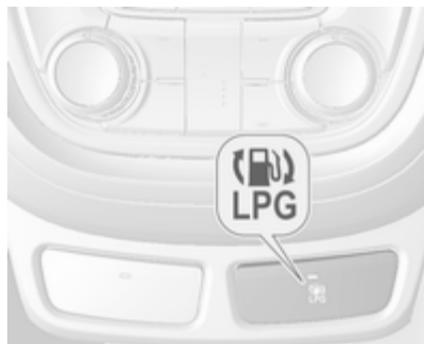
Durch Drücken der Taste **LPG** wird zwischen Benzin- und Flüssiggasbetrieb umgeschaltet, sobald die erforderlichen Parameter (Kühlmitteltemperatur, Gastemperatur und Mindestdrehzahl des Motors) erreicht sind. Die Anforderungen sind normalerweise nach etwa 60 Sekunden (je nach Außentemperatur) und der
