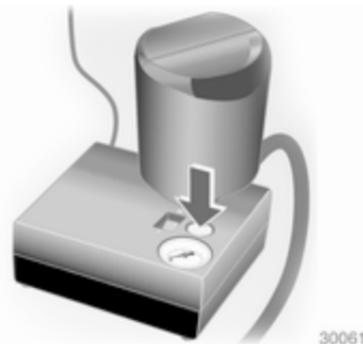
Wird der vorgeschriebene Reifendruck nicht innerhalb von 10 Minuten erreicht, Reifenreparaturset entfernen. Das Fahrzeug um eine Reifenumdrehung bewegen. Das Reifenreparaturset wieder anschließen und Füllvorgang 10 Minuten fortsetzen. Wird der vorgeschriebene Reifendruck danach immer noch nicht erreicht, ist der Reifen zu stark beschädigt. Hilfe einer Werkstatt in Anspruch nehmen.
