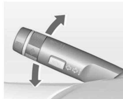
Hebel nach oben = Blinker rechts
