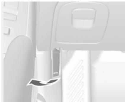
Entriegelungshebel ziehen und in die Ausgangsposition zurückführen.
