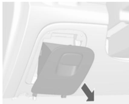
Der Sicherungsblock im Innenraum befindet sich auf der Fahrerseite unterhalb des Armaturenbretts.
