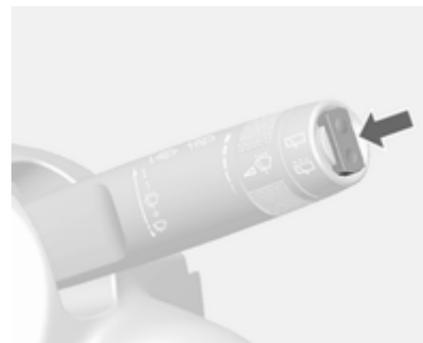
Zur Betätigung des Heckscheibenwischers Wippschalter drücken:
