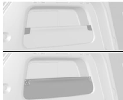
1. Beide Abdeckungen abnehmen und Schrauben entfernen. Blende ausbauen.
