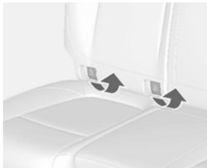
Die Abdeckungen der Führungsclappen beim Befestigen des Kindersicherheitsystems automatisch zurück.
