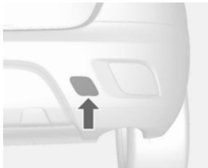
Kappe mit einem Schraubendreher lösen und abnehmen.
