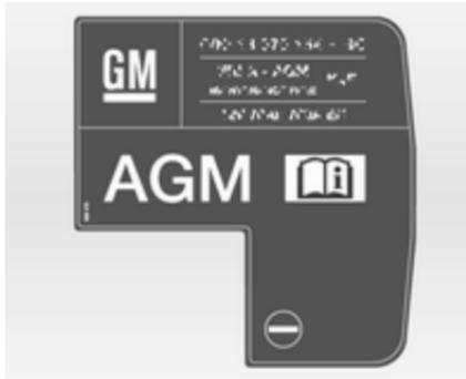
AGM-Batterien sind am Label an der Batterie zu erkennen. Wir empfehlen die Verwendung einer Original-Opel-Fahrzeuggatterie.
