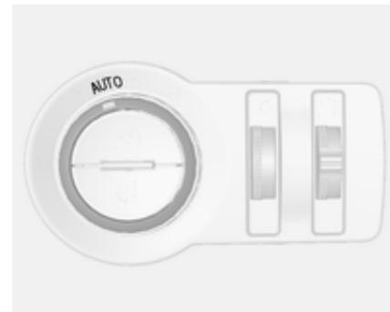
Wenn das automatische Fahrlicht bei laufendem Motor eingeschaltet wird, schaltet das System je nach den Lichtverhältnissen automatisch zwischen Tagfahr- und Abblendlicht um. Tagfahrlicht ⇨ 109.
