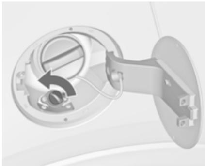
Die Schutzkappe vom Einfüllstutzen abschrauben.
