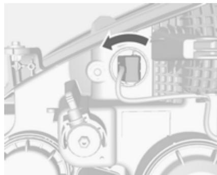
1. Lampenfassung durch Drehen gegen den Uhrzeigersinn ausrasten.
