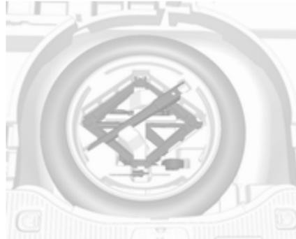
Wagenheber und Wagenwerkzeug befinden sich in einem Staufach über dem Ersatzrad im Laderaum.
