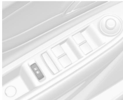
Die Zentralverriegelungstasten befinden sich an der Fahrer- und Beifahrertür.
