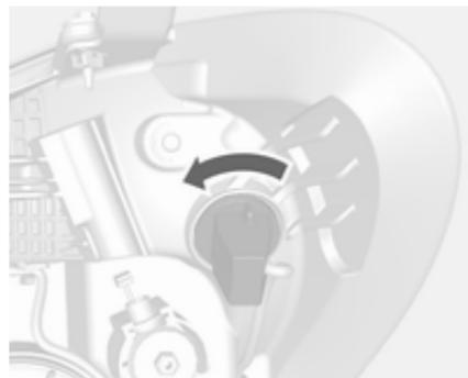
1. Fassung gegen den Uhrzeigersinn aus der Baugruppe herausdrehen.
