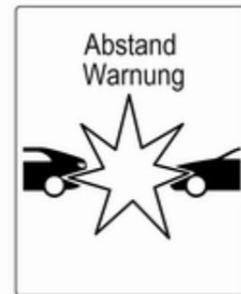
Beim zu schnellen Heranfahren an ein vorausfahrendes Fahrzeug wird die Auffahrwarnungsmeldung im Driver Information Center angezeigt. Gleichzeitig ertönt ein Warnton. Das Bremspedal betätigen, falls es die Situation erfordert.
