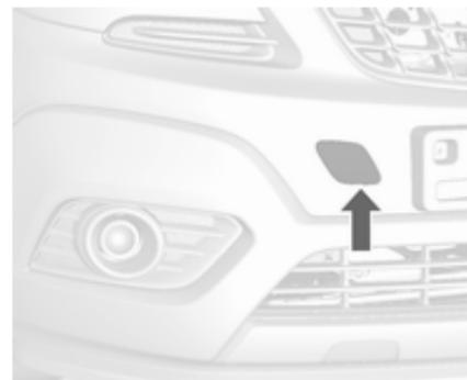
Kappe mit einem Schraubendreher lösen und abnehmen.
