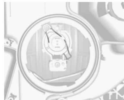
2. Den Federclip drücken und lösen.
