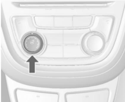
Die Heizung durch Drücken der Taste ☀ einschalten. Die Betätigung wird durch die LED auf der Taste angezeigt.
