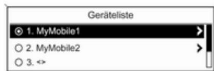
Gewünschtes Gerät auswählen. Ein Untermenü wird angezeigt.
