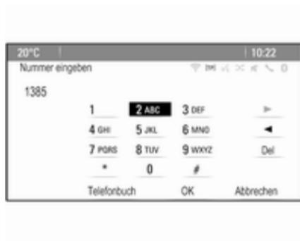
Die gewünschte Nummer eingeben. Die Bildschirmtaste **Del** auswählen oder die Taste **BACK** drücken, um die zuletzt eingegebene Ziffer zu löschen.
