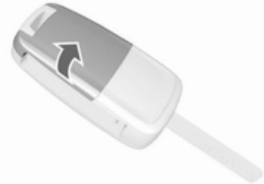
Schlüsselbart ausklappen und die Funkfernbedienung öffnen. Die Batterie austauschen (Batterietyp CR 2032). Die neue Batterie richtig einsetzen. Funkfernbedienung schließen und synchronisieren.
