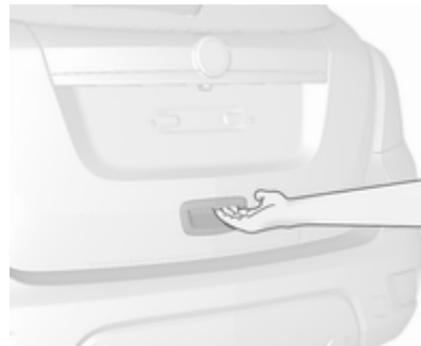
Nach dem Entriegeln den Touchpad-Schalter betätigen und die Hecktür öffnen.
