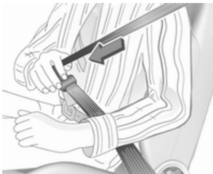
Den Gurt aus dem Aufroller herausziehen, unverdreht über den Körper legen und die Schloßzunge in das Gurtschloß einstecken, bis sie einrastet.
