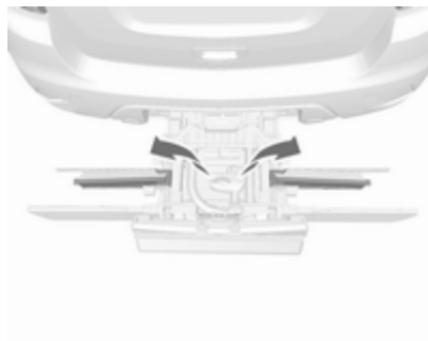
Gurt entfernen und Radaufnahme ausklappen.
