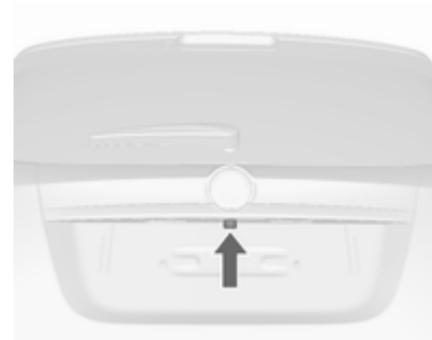
Die Kamera ist in den Hecktürgriff integriert und verfügt über einen Blickwinkel von 130°.
