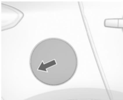
Die Tankklappe lässt sich nur bei entriegeltem Fahrzeug öffnen. Zum Öffnen auf die Klappe drücken.
