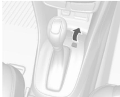
3. Die Abdeckung auf der Konsole mit einem dünnen Gegenstand wie etwa einem Schraubendreher entfernen.
