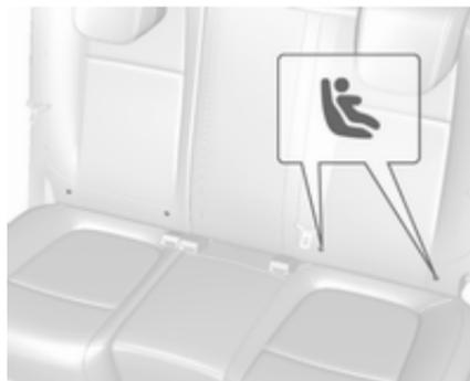
Die ISOFIX Befestigungsbügel sind durch Markierungen auf der Rückenlehne gekennzeichnet.
