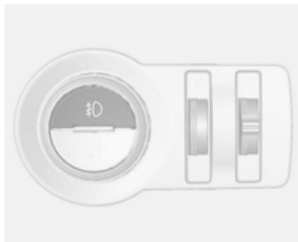
Wird durch Drücken von ☁ bedient.
