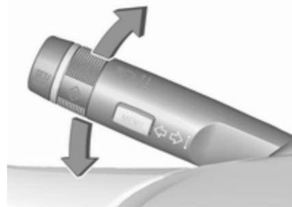
Hebel nach oben = Blinker rechts
