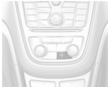
Die Heizung wird durch Drücken von
