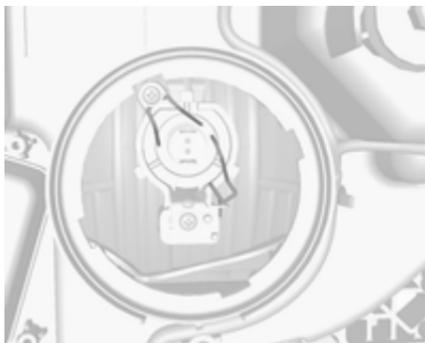
2. Den Federclip drücken und lösen.
