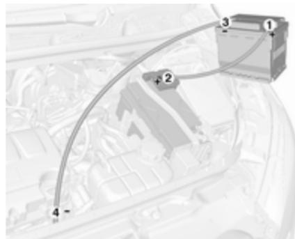
Reihenfolge für das Anschließen der Kabel:
