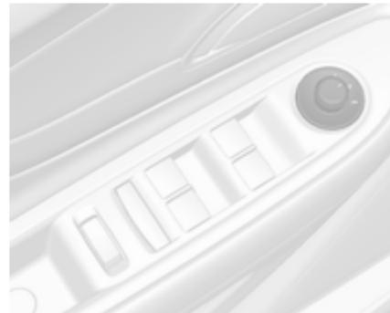
Gewünschten Außenspiegel durch Drehen des Bedienelements nach links (**L**) bzw. rechts (**R**) wählen. Danach das Bedienelement schwenken, um den Spiegel einzustellen.
