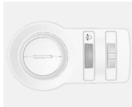
Zur Anpassung der Leuchtweite an die Fahrzeugbeladung, um Blendwirkung zu reduzieren: Daumenrad
