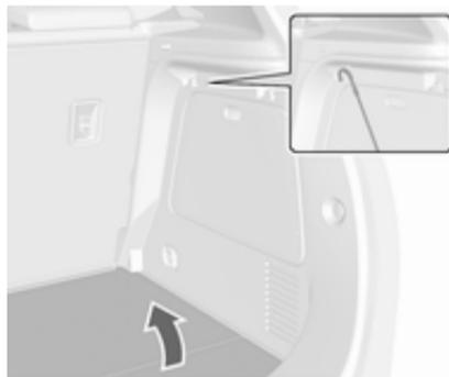
Abdeckung am Haken an der Seitenwand befestigen.
