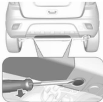
Beide Verriegelungstifte mit einem Schraubendreher lösen.
