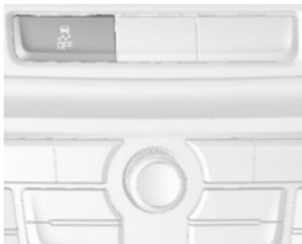
Für extremes Hochleistungsfahren kann ESC deaktiviert werden:
