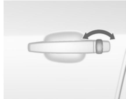
Fahrertür durch Drehen des Schlüssels im Schloss manuell entriegeln. Zündung einschalten und
