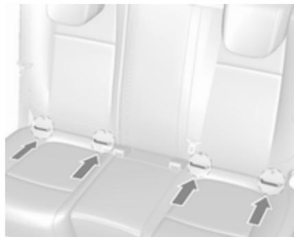
Für das Fahrzeug zugelassene ISOFIX-Kindersicherheits-systeme an den ISOFIX-Befestigungsbügeln befestigen. Die speziellen Positionen für ISOFIX Kindersicherheits-systeme sind in der Tabelle mit IL gekennzeichnet.
