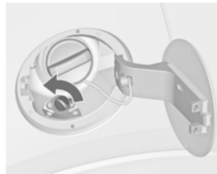
Die Schutzkappe vom Einfüllstutzen abschrauben.
