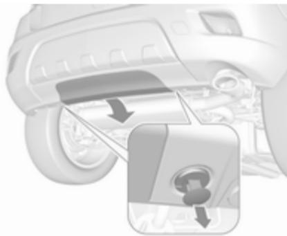
Beide Verriegelungstifte entfernen. Die Abdeckung nach vorn aus der Halterung ziehen und entfernen.
