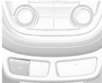
Beim Einlegen des Rückwärtsgangs wird das System automatisch aktiviert.
