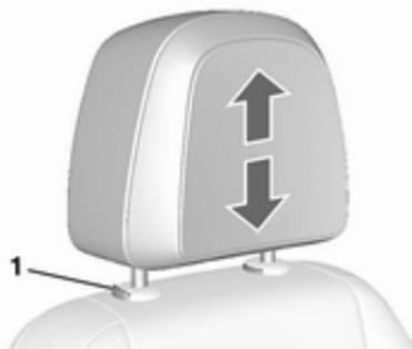
Kopfstütze nach oben ziehen. Auf die Verriegelung (1) drücken und die Kopfstütze nach unten drücken.
