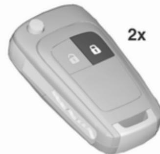
🔒 auf der Funkfernbedienung zweimal innerhalb von 5 Sekunden drücken.
