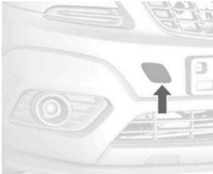
Kappe mit einem Schraubendreher lösen und abnehmen.
