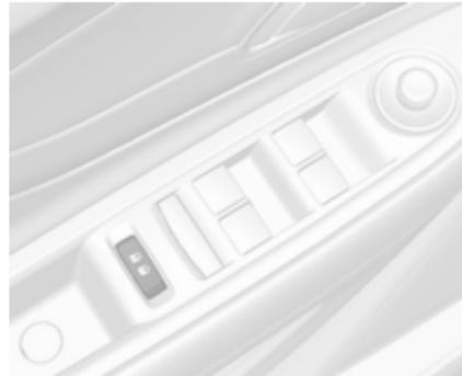
Die Zentralverriegelungstasten befinden sich in der Fahrertür.
