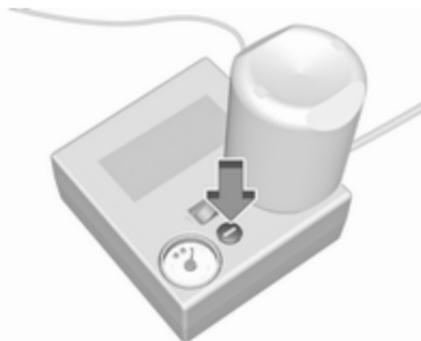
Wird der vorgeschriebene Reifendruck nicht innerhalb von 10 Minuten erreicht, Reifenreparaturset entfernen. Das Fahrzeug um eine Reifenumdrehung bewegen. Das Reifenreparaturset wieder anschließen und Füllvorgang 10 Minuten fortsetzen. Wird der vorgeschriebene Reifendruck danach immer noch nicht erreicht, ist der Reifen zu stark beschädigt. Hilfe einer Werkstatt in Anspruch nehmen.
