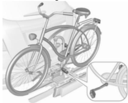
1. Die Pedale in die abgebildete Position drehen und das Fahrrad auf der Radaufnahme positionieren.
