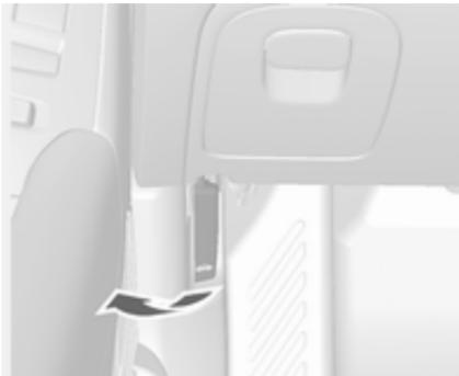
Entriegelungshebel ziehen und in die Ausgangsposition zurückführen.
