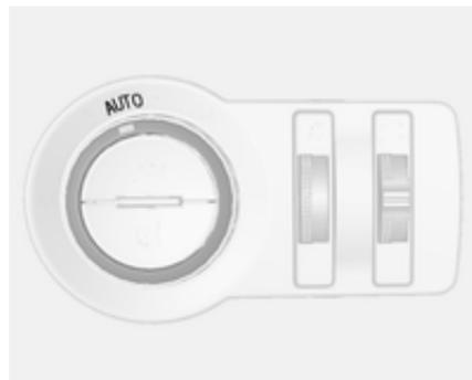
Wenn das automatische Fahrlicht bei laufendem Motor eingeschaltet wird, schaltet das System je nach den Lichtverhältnissen automatisch zwischen Tagfahr- und Abblendlicht um. Tagfahrlicht ⇨ 112.
