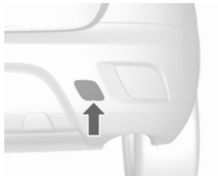
Kappe mit einem Schraubendreher lösen und abnehmen.
