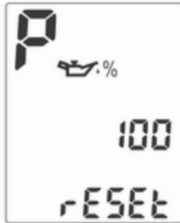
Im Uplevel-Display und Uplevel-Kombi-Display wird die restliche Öllebensdauer im **Fahrzeug Informationsmenü** angezeigt.
