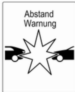
Wenn der Abstand zu einem vorausfahrenden Fahrzeug zu schnell sinkt, wird im DIC die Auffahrwarnung angezeigt. Gleichzeitig ertönt ein Warneton. Das Bremspedal betätigen, falls es die Situation erfordert.
