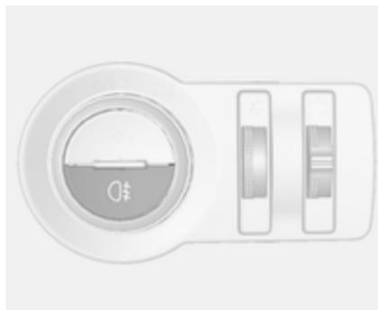
Wird durch Drücken von ☁ bedient.
