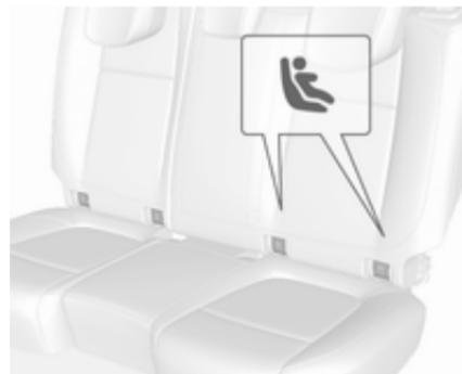
Bei einigen Fahrzeugen sind vor den Befestigungsbügeln Führungen angebracht, die den Einbau des Kindersicherheits-systems erleichtern.
