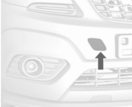
Kappe mit einem Schraubendreher lösen und abnehmen.
