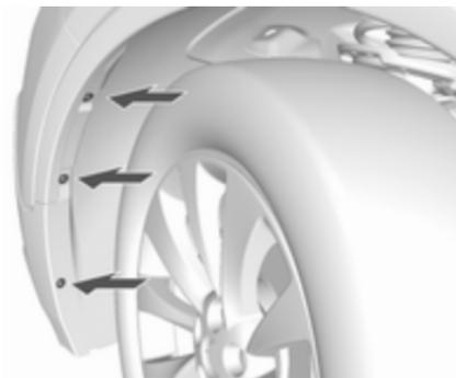
1. Das entsprechende Rad nach innen drehen, um besseren Zugriff zu erhalten. Die drei Torxschrauben außen am Radkasten entfernen. Wagenwerkzeug ⇨ 194.
