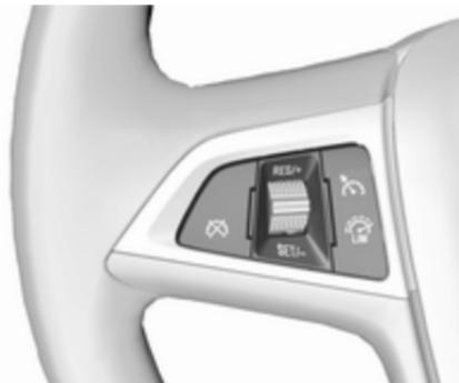
☰ drücken. Wenn zuvor der Geschwindigkeitsregler oder der adaptive Geschwindigkeitsregler aktiviert wurde, wird dieser beim Aktivieren des Geschwindigkeitsbegrenzers ausgeschaltet. Die Kontrollleuchte
