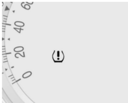
Wenn niedriger Reifendruck erkannt wird, wird dies durch die Kontrollleuchte (⚠) gemeldet ⇨ 88.
