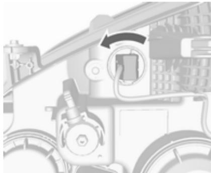
1. Die Lampenfassung linksherum drehen und lösen.
