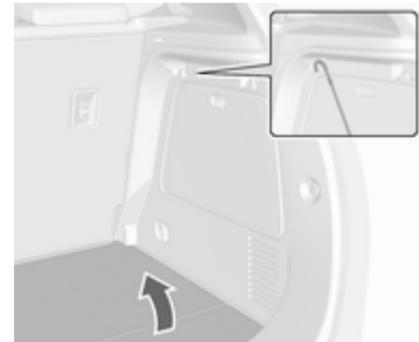
Abdeckung am Haken an der Seitenwand befestigen.
