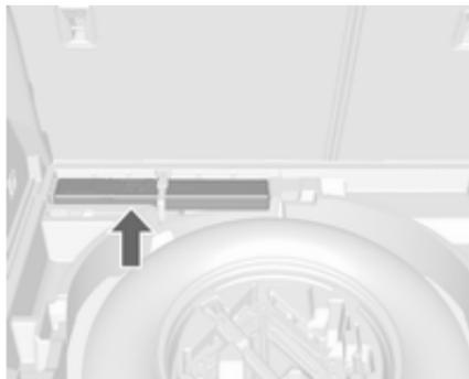
Das Warndreieck wird unter der Abdeckung des Laderaumbodens untergebracht. Mit dem Band fixieren.
