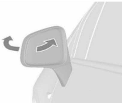
Zur Sicherheit von Fußgängern klappen die Außenspiegel bei Anstoßen aus ihrer Ausgangslage. Spiegel durch leichten Druck auf das Spiegelgehäuse wieder einrasten.
