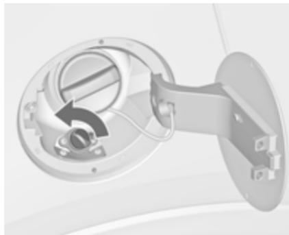
Die Schutzkappe vom Einfüllstutzen abschrauben.
