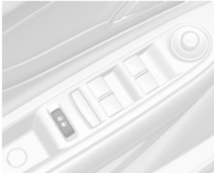
Die Zentralverriegelungstasten befinden sich in der Fahrertür.
