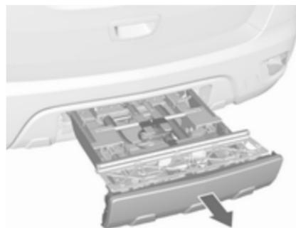
Das Heckträgersystem vollständig bis zum hörbaren Einrasten herausziehen.
