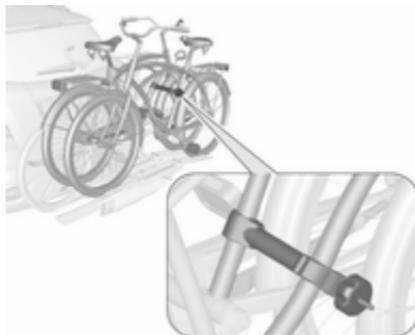
Das dritte Fahrrad mit der kurzen Zusatzhalterung befestigen. Die Halterung muss zwischen den Rahmen des zweiten und dritten Fahrrads fixiert werden.
