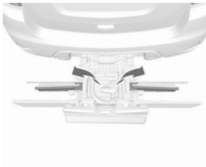
Gurt entfernen und Radaufnahme ausklappen.
