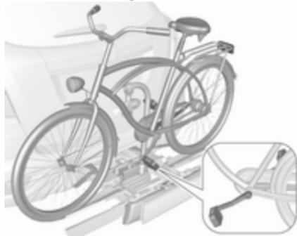
1. Die Pedale in die abgebildete Position drehen und das Fahrrad auf der Radaufnahme positionieren.
