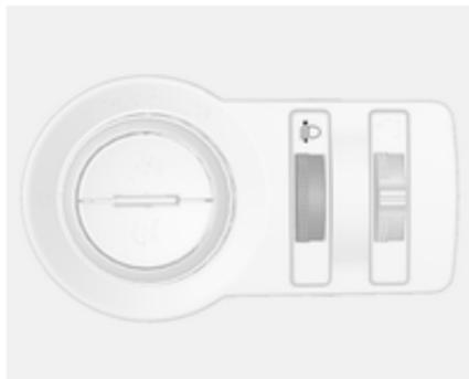
Zur Anpassung der Leuchtweite an die Fahrzeugbelastung, um Blendwirkung zu reduzieren: Daumenrad  $\text{⌚}$  in die gewünschte Stellung drehen.
