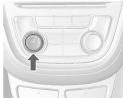
Die Heizung durch Drücken von ☀ einschalten. Die Betätigung wird durch die LED auf der Taste angezeigt.
