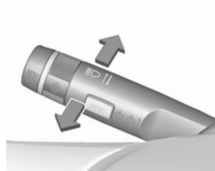
Zum Umschalten von Abblendlicht auf Fernlicht Hebel nach vorn drücken.
