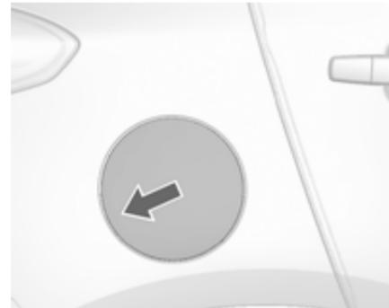
Die Tankklappe lässt sich nur bei entriegeltem Fahrzeug öffnen. Zum Öffnen auf die Klappe drücken.
