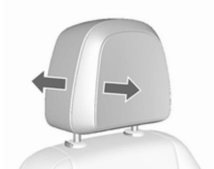
Für die Horizontaleinstellung Kopfstütze nach vorne ziehen. Sie rastet in drei Positionen ein.
