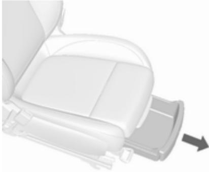
Ablagefach vorne anheben und herausziehen. Zum Schließen das Schubfach hineindrücken und einrasten lassen.
