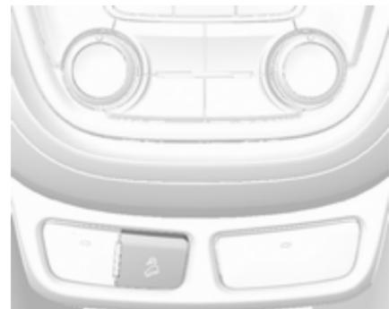
Bei Geschwindigkeiten unter ca. 40 km/h auf
