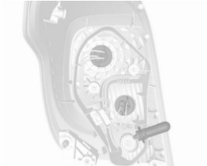
4. Lampenfassung herausnehmen. Glühlampe ausbauen und ersetzen.
