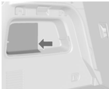
2. Zuerst einen Schraubendreher in die Aussparung einführen, um die Abdeckung auszurasten. Dann die Abdeckung vorne und oben ausrasten. Abdeckung abnehmen.
