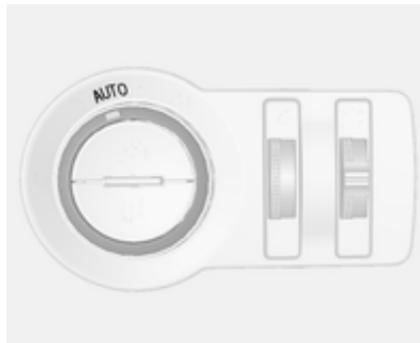
Wenn das automatische Fahrlicht bei laufendem Motor eingeschaltet wird, schaltet das System je nach den Lichtverhältnissen automatisch zwischen Tagfahr- und Abblendlicht um. Tagfahrlicht ⇨ 113.
