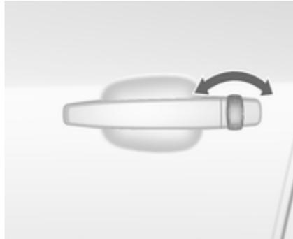
Fahrertür durch Drehen des Schlüssels im Schloss manuell entriegeln. Zündung einschalten und
