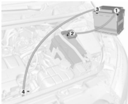
Reihenfolge für das Anschließen der Kabel:
