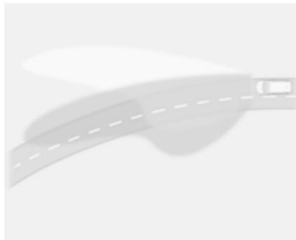
Der Lichtstrahl wird auf Basis des Lenkwinkels und der Geschwindigkeit geschwenkt, was die Ausleuchtung von Kurven verbessert.
