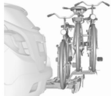
Das Heckträgersystem (Flex-Fix-System) bietet die Möglichkeit, ein Fahrrad auf einem in den Fahrzeugboden integrierten herausziehbaren Träger zu befestigen. Auf einem Anbaustück können zwei weitere Fahrräder befestigt werden. Der Transport anderer Gegenstände ist nicht zulässig.
