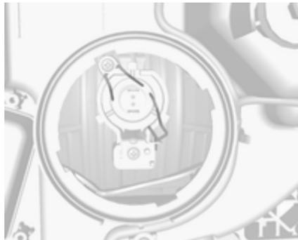
2. Den Federclip drücken und lösen.
