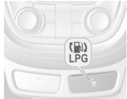
Durch Drücken von **LPG** wird zwischen Benzin- und Flüssiggasbetrieb umgeschaltet, sobald die erforderlichen Parameter (Kühlmitteltemperatur, Gastemperatur und Mindestdrehzahl des Motors) erreicht sind. Die Anforderungen sind normalerweise nach etwa 60 Sekunden (je nach Außentemperatur) und der ersten festen Betätigung des Gaspedals erreicht. Die LED-Statusleuchte zeigt den aktuellen Betriebsmodus.
