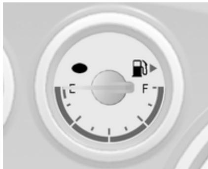
Zeigt je nach Betriebsmodus den Füllstand des Kraftstofftanks oder des Gastanks an.
