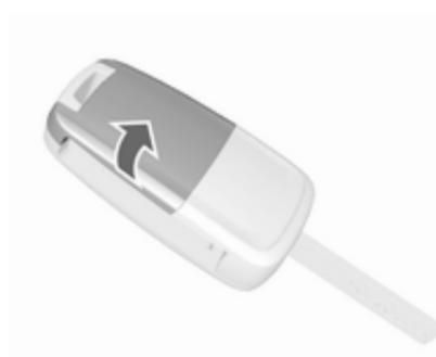
Schlüsselbart ausklappen und die Funkfernbedienung öffnen. Die Batterie austauschen (Batterietyp CR 2032). Die neue Batterie richtig einsetzen. Funkfernbedienung schließen und synchronisieren.
