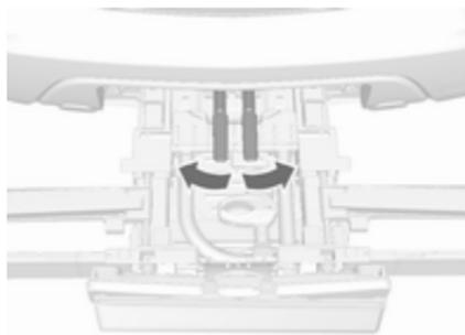
Gurt abnehmen und die beiden Spannhelbe so weit wie möglich zur Seite schwenken.
