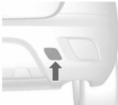
Kappe mit einem Schraubendreher lösen und abnehmen.
