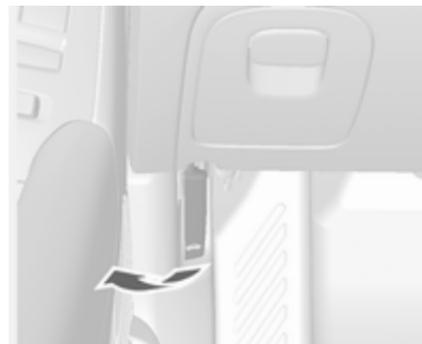
Entriegelungshebel ziehen und in die Ausgangsposition zurückführen.
