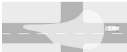
Wird bei Geschwindigkeiten von bis ca. 55 km/h automatisch aktiviert. Bei Bedingungen mit Umgebungshelligkeit werden beide Abbiegelichter mit reduzierter Intensität eingeschaltet. Das Licht ist weit und symmetrisch.
