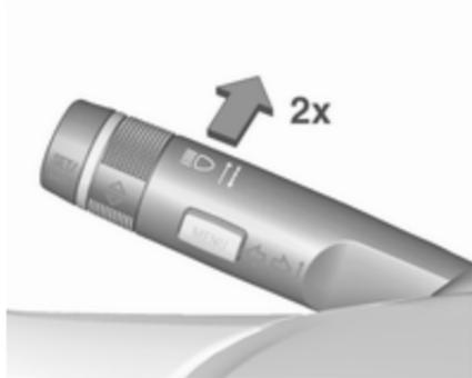
Der Fernlichtassistent wird durch zweimaliges Drücken des Blinkerhebels aktiviert. Bei Geschwindigkeiten über 40 km/h wird das Fernlicht automatisch eingeschaltet.
