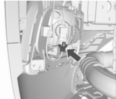
3. Die Halterippe nach außen ziehen und den Steckverbinder aus der Glühlampenfassung entfernen.
