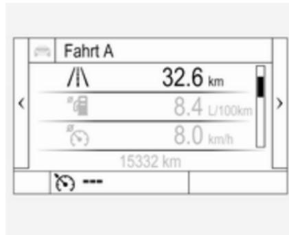
**Info** Seite **i** durch Drücken auf **Menu** auswählen. Seite **Trip A** oder **Trip B** durch Drehen des Einstellrädchens am Blinkerhebel wählen.
