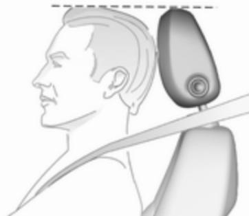
Die Oberkante der Kopfstütze sollte mit der Oberkante des Kopfes abschließen. Ist dies bei sehr großen Personen nicht möglich, höchste Position einstellen, bei sehr kleinen Personen tiefste Position.
