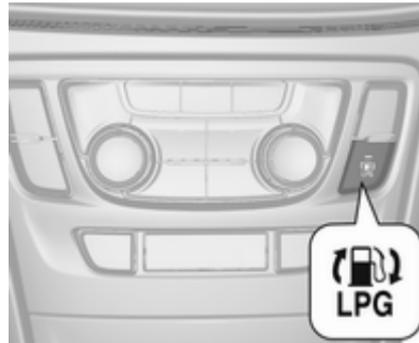
Durch Drücken von **LPG** wird zwischen Benzin- und Flüssiggasbetrieb umgeschaltet, sobald die erforderlichen Parameter (Kühlmitteltemperatur, Gastemperatur und Mindestdrehzahl des Motors) erreicht sind. Die Anforderungen sind normalerweise nach etwa 60 Sekunden (je nach Außentemperatur) und der
