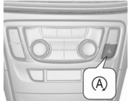
Die Stopp-Start-Automatik lässt sich durch Drücken von **A** manuell deaktivieren. Die Deaktivierung wird durch das Erlöschen der LED in der Taste angezeigt.
