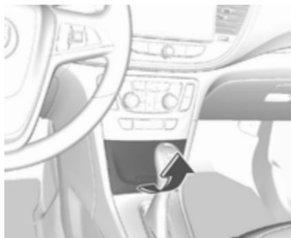
Eine 12-V-Zubehörsteckdose befindet sich in der vorderen Konsole hinter der Abdeckung. Zum Öffnen Knopf drücken.
