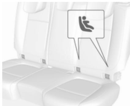
Bei einigen Fahrzeugen sind vor den Befestigungshalterungen Führungen angebracht, die den Einbau des Kindersicherheitsystems erleichtern.
