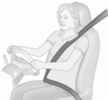
Bei starker Beschleunigung oder Verzögerung des Fahrzeugs blockieren die Sicherheitsgurte, um die Insassen in ihrer Sitzposition zu halten. Daher ist die Verletzungsgefahr deutlich geringer.
