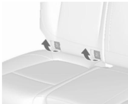
Die Abdeckungen der Führungen klappen beim Befestigen des Kindersicherheitsystems automatisch zurück.
