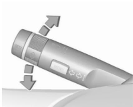
Hebel nach oben : Blinker rechts
