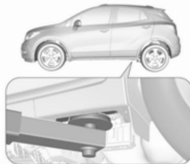
Position des hinteren Arms der Hebebühne mittig unter der Aussparung im Schweller.
