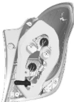
4. Lampenfassung herausnehmen. Glühlampe ausbauen und ersetzen.
