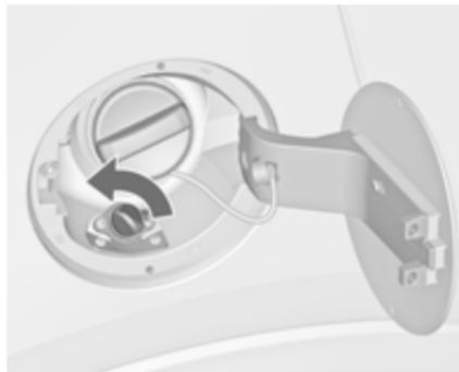
Die Schutzkappe vom Einfüllstutzen abschrauben.
