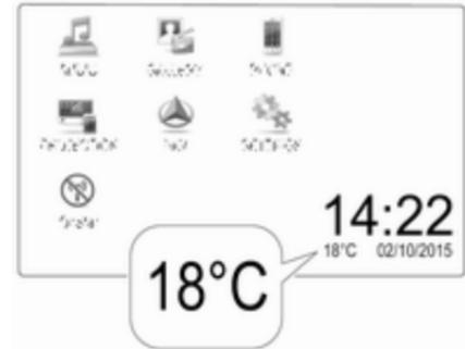
Ein Temperaturabfall wird sofort angezeigt, ein Temperaturanstieg mit Verzögerung.
