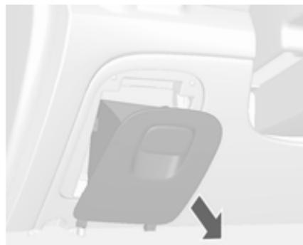
Bei Linklenkern befindet sich der innere Sicherungskasten auf der Fahrerseite unterhalb des Armatu-
