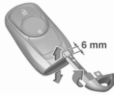
2. Das Schlüsselblatt ca. 6 mm in das Gehäuse einstecken und den Schlüssel drehen, um das Gehäuse zu öffnen. Wenn das Schlüsselblatt zu weit eingeführt wird, kann dies das Gehäuse beschädigen.
