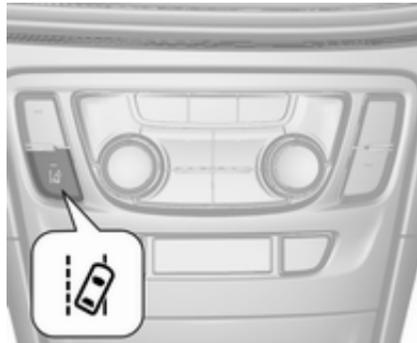
Die Spurverlassenswarnung wird durch Drücken auf
