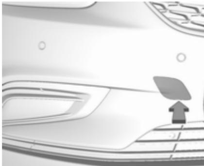
Die Spitze eines Schlitzschraubendrehers mit einem Tuch umwickeln, um den Lack zu schützen. Mit dem Schraubendreher in den Schlitz unten an der Abdeckung fahren. Abdeckung durch vorsichtiges Abwärtsbewegen des Schraubendrehers lösen. Die Abschleppöse befindet sich beim Wagenwerkzeug ⇨ 212.
