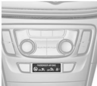
Solange die Kontrollleuchte  $\text{OFF} \frac{80}{2}$  nicht aufleuchtet, löst das Beifahrer-Airbag-System bei einer Kollision aus.
