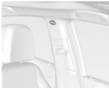
Das Kopf-Airbag-System wird bei einem Seitenaufprall ab einer bestimmten Unfallschwere ausgelöst. Die Zündung muss eingeschaltet sein.
