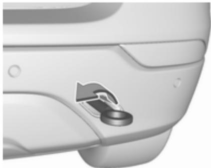
Abschleppöse bis zum Anschlag in waagerechter Stellung einschrauben.
