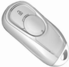
Die Zentralverriegelung kann auch über die Tasten am elektronischen Schlüssel bedient werden.
