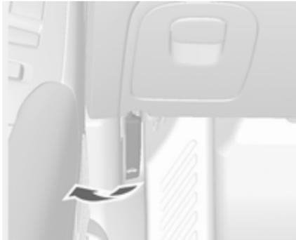
Entriegelungshebel ziehen und in die Ausgangsposition zurückführen.
