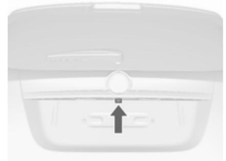
Die Kamera ist in den Hecktürgriff integriert und verfügt über einen Blickwinkel von 130°.
