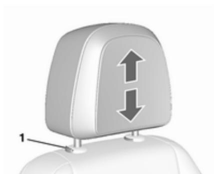
Kopfstütze nach oben ziehen. Auf die Verriegelung (1) drücken und die Kopfstütze nach unten drücken.
