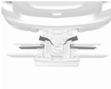
Gurt entfernen und Radaufnahme ausklappen.
