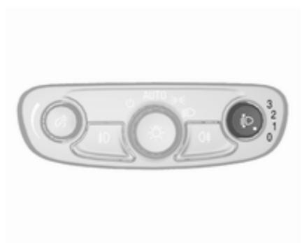
Zur Anpassung der Leuchtweite an die Fahrzeugbeladung, um Blendwirkung zu reduzieren: Daumenrädchen ↻ in die gewünschte Stellung drehen.
