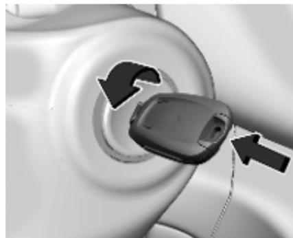
3. Den Schlüssel vollständig in Richtung Lenksäule drücken und dann in Stellung **0** drehen.
