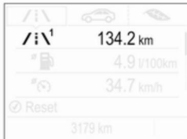
/i\ durch Drücken auf **Menu** am Blinkerhebel auswählen. Das Einstellrädchen drehen und /i\1 oder /i\2 auswählen. Jede Tageskilometerzählerseite kann separat zurückgesetzt werden, indem während der Anzeige des entsprechenden Menüs einige Sekunden lang **SET/CLR** am Blinkerhebel gedrückt wird.
