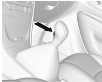
Zum Einlegen des Rückwärtsgangs bei stehendem Fahrzeug das Kupplungspedal treten, den Entriegelungsknopf am Wählhebel drücken und den Gang einlegen.
