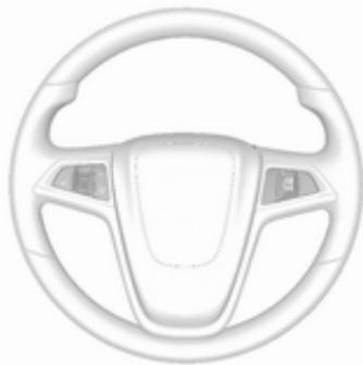
Der Geschwindigkeitsregler und der Geschwindigkeitsbegrenzer werden über die Bedienelemente links am Lenkrad bedient.
