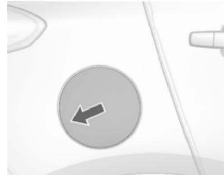
Die Tankklappe lässt sich nur bei entriegeltem Fahrzeug öffnen. Tankklappe durch Drücken der Klappe lösen.
