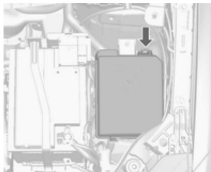
Der Sicherungskasten befindet sich im Motorraum.
