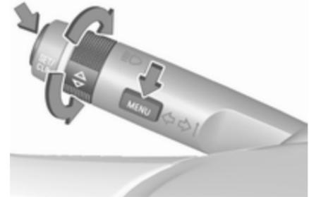
Im Midlevel-Display das Menü **Option** durch Drücken auf **MENU** am Blinkerhebel anwählen. Zum Auswählen der Seite **Restliche Lebensdauer Öl** das Einstellrädchen drehen.
