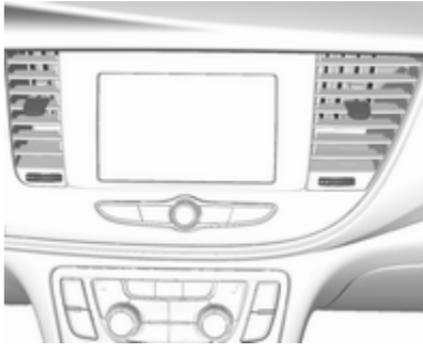
Zum Öffnen der Düse das Einstellrädchen rechtsherum drehen. Durch Drehen am Einstellrädchen die Luftmenge an der Düse einstellen.
