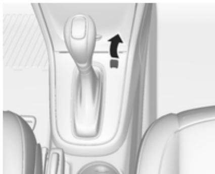
2. Die Abdeckung auf der Konsole mit einem dünnen Gegenstand wie etwa einem Schraubendreher entfernen.
