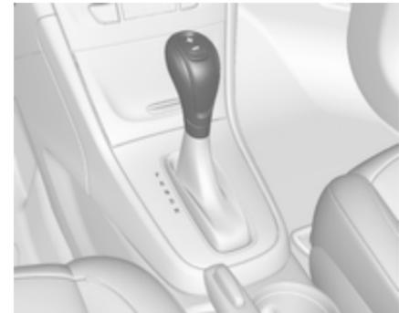
**P** : Parkstellung, Räder sind blockiert; nur bei stillstehendem Fahrzeug und betätigter Parkbremse einlegen
