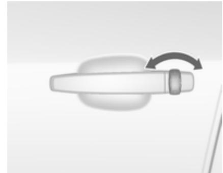
Die Fahrertür durch Einsetzen und Drehen des Schlüssels im Schließzylinder von Hand entriegeln.
