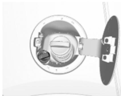
4. Die Schutzkappe vom Einfüllstutzen abschrauben.
