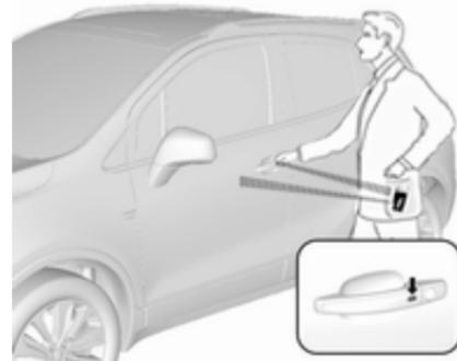
Der elektronische Schlüssel muss sich außerhalb des Fahrzeugs in einem Umkreis von ca. 1 m um die entsprechende Türseite befinden.
