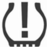
Wenn niedriger Reifendruck erkannt wird, wird dies durch die Kontrollleuchte (⚠) gemeldet ⇨ 99.
