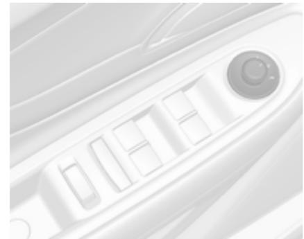
Gewünschten Außenspiegel durch Drehen des Bedienelements nach links (**L**) bzw. rechts (**R**) wählen. Danach das Bedienelement schwenken, um den Spiegel einzustellen.
