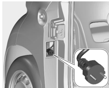
Das Ladekabel ist fest mit dem Fahrzeug verbunden. Es ist im Rahmen der Beifahrertür untergebracht.
