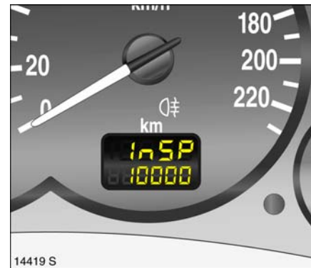
InSP Service-Intervall Anzeige * Bei Aufleuchten im Display des Kilometerzählers möglichst bald Service-Termin für Wartungsarbeiten mit einer Werkstatt abstimmen. Wir empfehlen, sich an Ihren Opel Partner zu wenden. Wartung, Inspektionssystem, siehe Seite 162.
