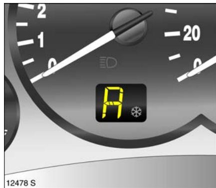
Getriebe-Display * Anzeige des aktuellen Ganges oder Modus bei Easytronic *. Weitere Hinweise siehe Seite 106.
