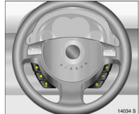
**Auswahl mit den Tasten** ⚙️ **am Lenkrad**
