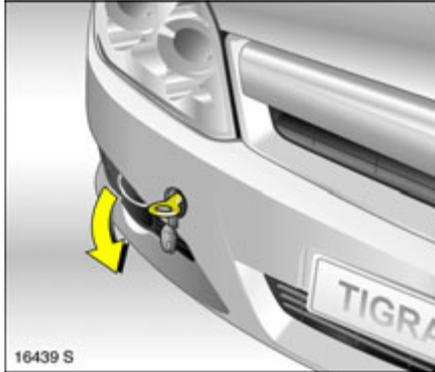
Abschleppöse links herum einschrauben und bis zum Anschlag in waagerechte Stellung festdrehen.
