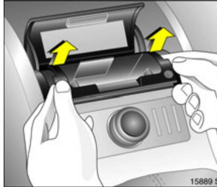
Zum Entleeren Ascherabdeckung über den Druckpunkt hinaus bis zum Anschlag aufklappen, wodurch der Einsatz angehoben wird. Einsatz beidseitig fassen und nach oben herausziehen.
