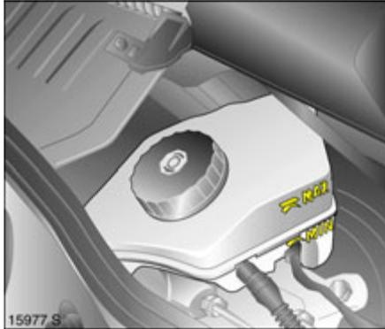
Der Bremsflüssigkeitsstand muss zwischen **MIN** und **MAX** stehen.
