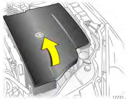
**Sicherungskasten im Motorraum**
