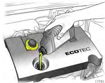
Zum Nachfüllen diejenige Motorölmarke verwenden, die beim vorangegangenen Motorölwechsel eingefüllt wurde, Hinweise im Serviceheft beachten.
