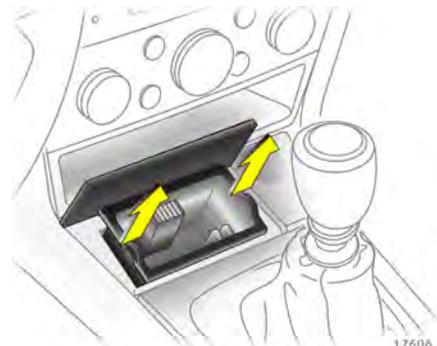
Zum Entleeren Einsatz beidseitig an den im Bild gezeigten Stellen fassen und nach oben herausziehen.
