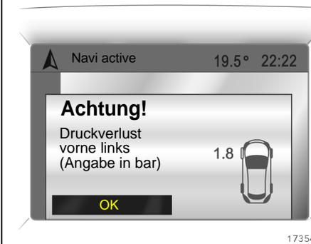
Gleichzeitig erscheint eine Grafik \* mit Kennzeichnung des vorderen linken Reifens und der Anzeige des aktuellen Reifendruckes: Erheblicher Druckunterschied oder direkter Druckverlust! Schnellstmöglich aus dem fließenden Verkehr ohne Behinderung anderer Fahrzeuge fahren, anhalten und Reifen und Reifendruck überprüfen. Gegebenenfalls Reserverad montieren, siehe Seiten 236, 238.
