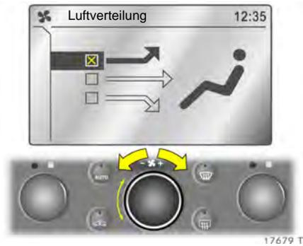
Die einzelnen Menüpunkte werden durch Drehen des zentralen Drehknopfes markiert und durch Drücken ausgewählt. Bei einigen Menüpunkten wird ein weiteres Menü angezeigt, sobald das entsprechende Menü durch Drücken ausgewählt wurde.
