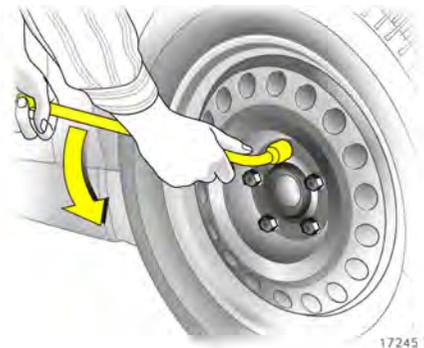
2. Radschrauben mit Radschraubensteckschlüssel ✱ eine halbe Umdrehung lösen, dabei Radschraubensteckschlüssel ✱ bis zum Anschlag aufstecken.
