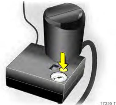
Wird der vorgeschriebene Reifendruck innerhalb von 10 Minuten nicht erreicht, das Reifenreparaturset abbauen. Das Fahrzeug um eine Reifenumdrehung, ca. 2 Meter in oder gegen die Fahrtrichtung bewegen. Das Reifenreparaturset wieder anschließen und Befüllvorgang 10 Minuten fortsetzen. Wird der vorgeschriebene Reifendruck danach immer noch nicht erreicht, ist der Reifen zu stark beschädigt. Fahrzeug abstellen und Hilfe einer Werkstatt in Anspruch nehmen.
