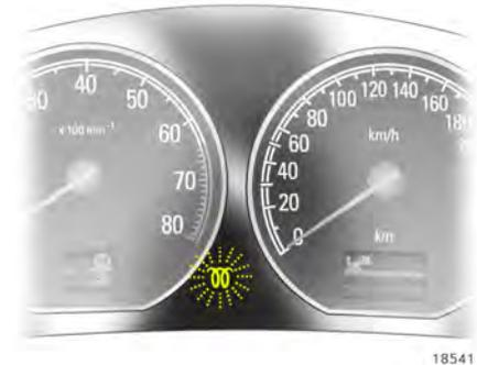
Wenn das Filter gereinigt werden muss und die letzten Fahrbedingungen die Reinigung nicht automatisch zuließen, dann blinkt die Kontrollleuchte
