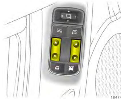
Bedienung mit 2 Wipptasten in der Fahrertür. Zusätzliche Wipptasten in der Beifahrertür und in den hinteren Türen \*.
