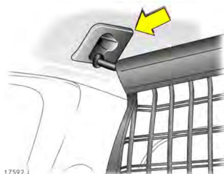
Netz aus Kassette herausziehen. Im Dachrahmen sind zwei Montageöffnungen. Stangen des Netzes erst auf einer, dann auf der anderen Seite in Montageöffnungen einhängen und nach vorn einrasten. Gepäckraumabdeckung einbauen.
