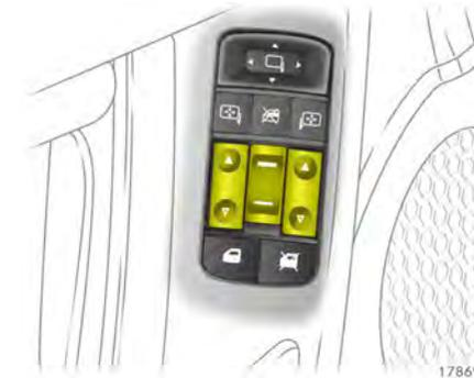
Bei Fahrzeugen mit hinterer \* elektronischer Fensterbetätigung Schiebeschalter zwischen den Tasten in der Fahrertür
