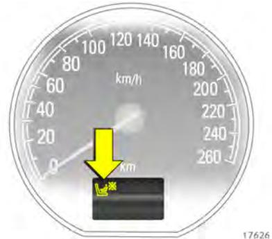
Leuchtet die Kontrollleuchte während der Fahrt nicht, sind der Front- und Seiten-Airbag für den Beifahrer nicht deaktiviert, es besteht Lebensgefahr für das Kind, Kindersicherheitsystem auf dem Rücksitz montieren. Störungsursache von einer Werkstatt beheben lassen.
