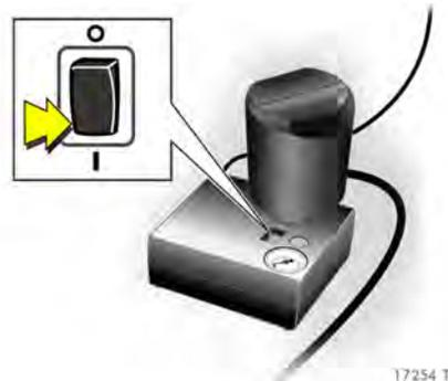
11. Wippschalter am Kompressor auf I stellen, der Reifen wird mit dem Dichtmittel gefüllt.
