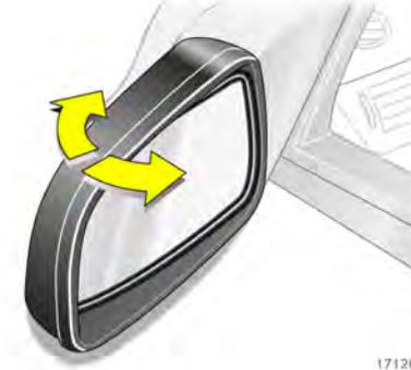
Zur Sicherheit für Fußgänger klappen die Außenspiegel bei Anstoßen aus ihrer Ausgangslage. Durch leichten Druck wieder einrasten.
