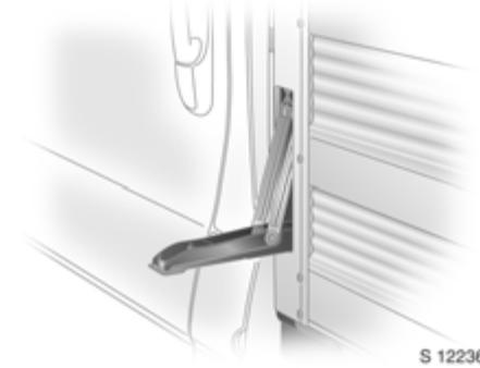
Den Hebel bis zum Anschlag an die Pritsche herunterziehen und die Seitenwand vorsichtig absenken.
