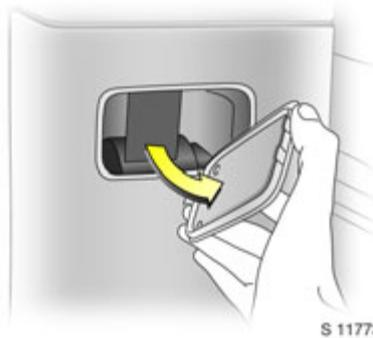
Bei einer Unterbrechung der Stromversorgung wird die Tankklappe nicht mit der Zentralverriegelung entriegelt ✱. Sie muss dann von Hand gelöst werden.
