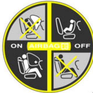
Das Deaktivierungssystem der Airbagsysteme des Beifahrersitzes wird durch ein Etikett an der Seite der Instrumententafel angezeigt, das bei geöffneter Beifahrertür sichtbar ist.
