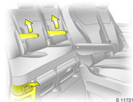
Beim Umklappen oder Ausbauen des hinteren Sitzes darauf achten, dass die Armlehnen \* sich in aufrechter Position befinden. Auch die unteren Seitentaschen der Sitzverkleidung \* ausbauen, indem sie von ihren Halteklammern gelöst werden.
