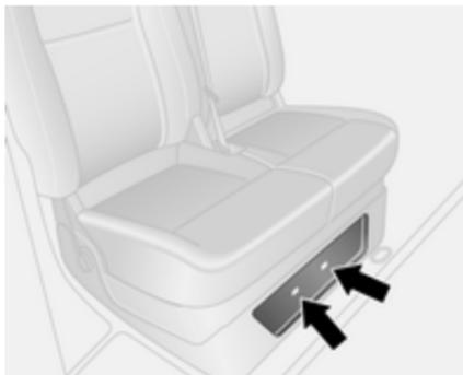
Die unteren Verkleidungskappen können gelöst werden, um lange Gegenstände unter den Rücksitzen zu verstauen. Die vordere Klappe nach innen klappen und die Lasche hinter dem Sitz ziehen, um die hintere Klappe zu öffnen.
