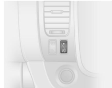
Das Stopp-Start-System manuell durch Drücken der Taste
