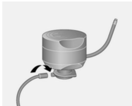
3. Luftschlauch an den Anschluss der Dichtmittelflasche schrauben.
