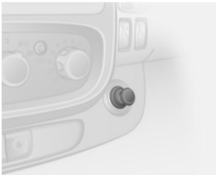
12-V-Zubehörsteckdosen befinden sich auf der Instrumententafel und hinten im Fahrzeug.
