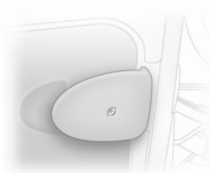
Die Türen werden von Feststellern in der 90°-Stellung gehalten. Zum Öffnen der Türen auf 180° oder mehr die Entriegelungsgriffe ziehen und die Türen in die gewünschte Stellung öffnen.
