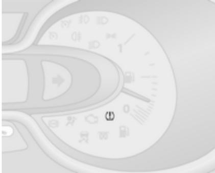
Wird ein zu niedriger Reifendruck erkannt, wird dies durch Aufleuchten der Kontrollleuchte (⚠) ⇨ 87 angezeigt, und im Driver Information Center wird eine entsprechende Meldung angezeigt.
