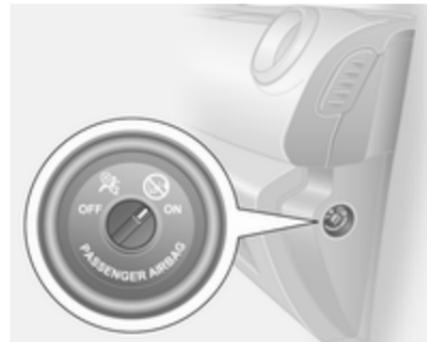
Das Beifahrer-Airbag-System lässt sich mit einem Schalter seitlich an der Instrumententafel deaktivieren. Die vordere Beifahrertür öffnen, um auf den Schalter zurückzugreifen.
