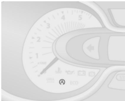
Ein Autostop wird durch das Aufleuchten von (A) im Instrument angezeigt ⇨ 88.
