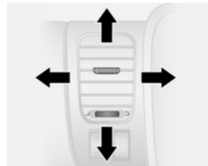
Um die mittleren Belüftungsdüsen zu öffnen oder schließen und den Luftstrom einzustellen, die Lamellen nach
