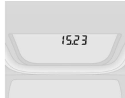
Die Uhreinstellfunktion durch wiederholtes Drücken der Taste am Ende des Wischerhebels aufrufen.
