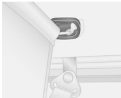
Die Abdeckungen im Dachhimmel lösen, um die Halterungen freizulegen, dann die Laderaumnetzstangen in die linken und rechten Halterungen stecken und sichern.
