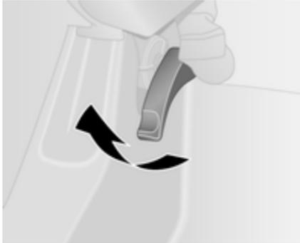
Entriegelungshebel ziehen und in die Ausgangsposition zurückführen.
