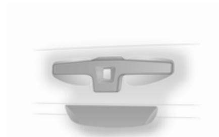
Nach Entriegelung den Hecktürknopf drücken und die Hecktür auf die vollständig geöffnete Position anheben.
