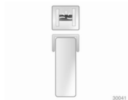
Eine defekte Sicherung ist am durchgebrannten Schmelzfaden erkennbar. Sicherung nur dann ersetzen, wenn die Ursache für die Störung behoben wurde.
