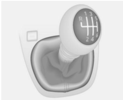
Zum Einlegen des Rückwärtsgangs bei stehendem Fahrzeug das Kupplungspedal treten, den Ring am Schalthebel nach oben ziehen und den Gang gegen den Widerstand einlegen.
