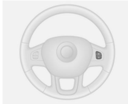
Den Schalter **O** drücken: Der Geschwindigkeitsregler wird deaktiviert und die grüne Kontrollleuchte
