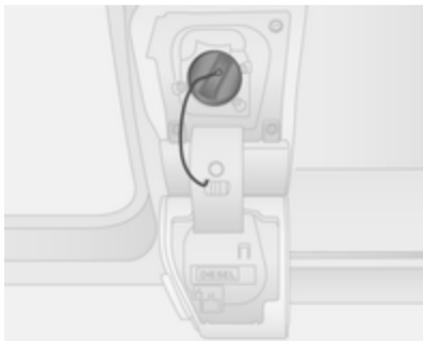
Um den Tankdeckel zu öffnen, entgegen dem Uhrzeigersinn drehen. Der Tankdeckel kann in die Halterung auf der Tankklappe eingehängt werden.
