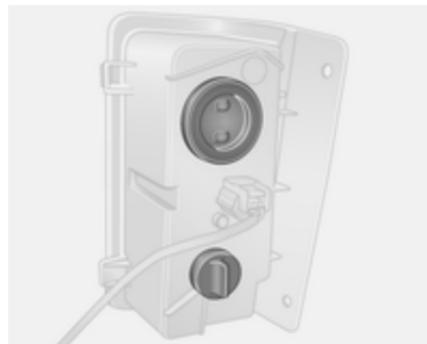
1. 2 Schrauben lösen (mit dem mitgelieferten Werkzeug) und Leuchte abbauen.
