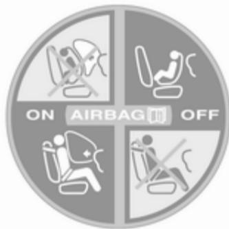
Das System der Airbagabschaltung kann durch einen Aufkleber an der Seite der Instrumententafel gekennzeichnet und bei geöffneter Beifahrertür sichtbar sein.
