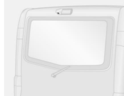
Die Kamera ist über den hinteren Türen/Hecktür montiert.
