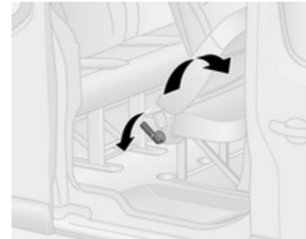
Um besseren Zugang zu den Rücksitzen zu erhalten, Entriegelungshebel ziehen und Rückenlehne nach vorne klappen. Falls erforderlich, die Sicherheitsgurte aus ihren Schließern lösen.
