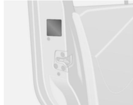
Reifendrucke ⇨ 188. Die Reifen immer auf die Druckwerte aufblasen, die auf dem Aufkleber am Fahrertür-rahmen stehen.
