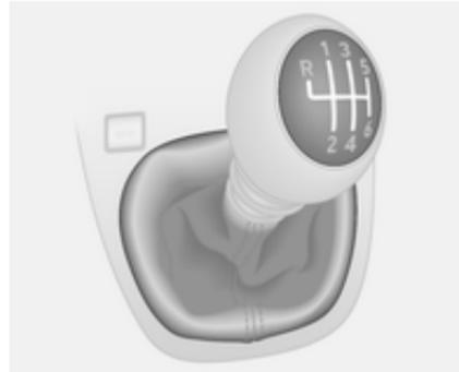
Rückwärtsgang: Nach Betätigung des Kupplungspedals bei stehendem Fahrzeug 3 Sekunden warten, anschließend Ring am Schalthebel nach oben ziehen und Gang einlegen.
