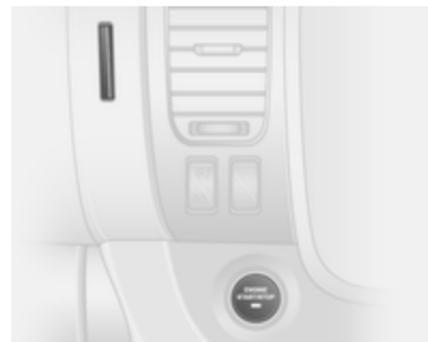
Der elektronische Schlüssel muss sich innerhalb des Fahrzeugs befinden, entweder im Kartenleser oder im vorderen Fahrgastraum.
