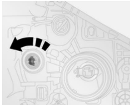
1. Lampenfassung durch Drehung nach links vom Reflektorgehäuse lösen.
