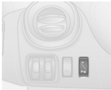
Das System durch Drücken der Taste **P**
