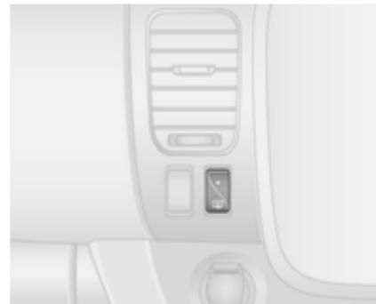
Die Heizung wird durch Drücken der Taste ☒ bedient.
