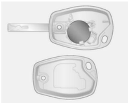
Batterie (Batterietyp CR 2016) austauschen und die neue Batterie richtig einsetzen.
