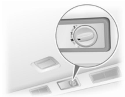
Der Luftdurchsatz wird durch das Gebläse bestimmt. Die Lufttemperatur wird mit dem Temperaturregler an der Instrumententafel eingestellt.
