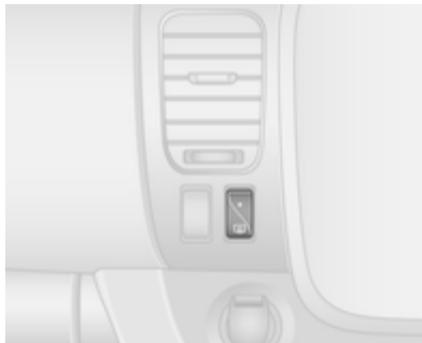
Wird durch Drücken der Taste
