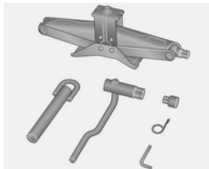
Wagenheber, Radschlüssel, Radschraubenhülse, Torx-Schlüssel, Adapter, Haken für Radabdeckung, Abschleppöse sind in einer Einheit zusammengefasst und unter dem Fahrersitz verstaut.
