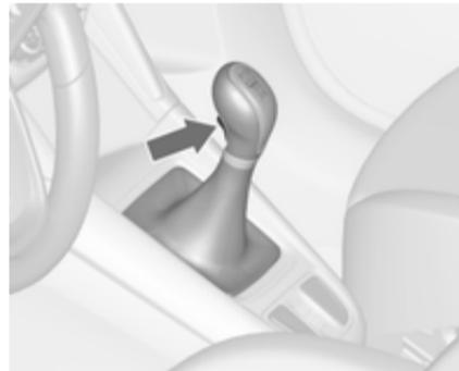
Zum Einlegen des Rückwärtsgangs nach Betätigen des Kupplungspedals bei stehendem Fahrzeug 3 Sekunden warten, anschließend den Entriegelungsknopf am Wählhebel drücken und den Gang einlegen. Lässt sich der Gang nicht einlegen, Wählhebel in Leerlaufstellung führen, Kupplungspedal loslassen und wieder betätigen. Nochmals schalten. Kupplung nicht unnötig schleifen lassen.
