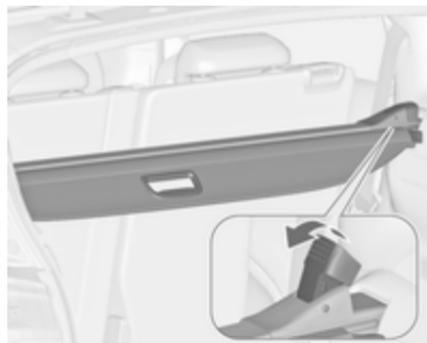
Laderaumabdeckung öffnen. Entriegelungshebel nach oben ziehen und halten. Abdeckung rechts anheben und aus den Aufnahmen nehmen.
