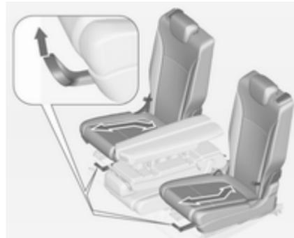
In der Komfortposition können die äußeren Sitze zudem seitlich verschoben werden, wenn die Rückenlehne des mittleren Sitzes umgeklappt wurde und als Armlehne verwendet wird.
