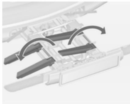
Beide Radaufnahmen ausklappen.
