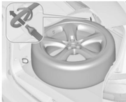
2. Das Schlaufenende des Gurtes durch die vordere Zurröse an der linken Seite führen.
