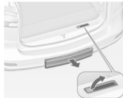
Den Entriegelungshebel nach oben ziehen. Das Heckträgersystem rastet aus und fährt schnell aus dem hinteren Stoßfänger.
