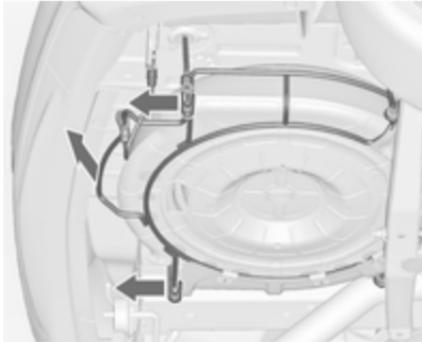
5. Die Reserveradhalterung anheben und beide Verriegelungen lösen.
