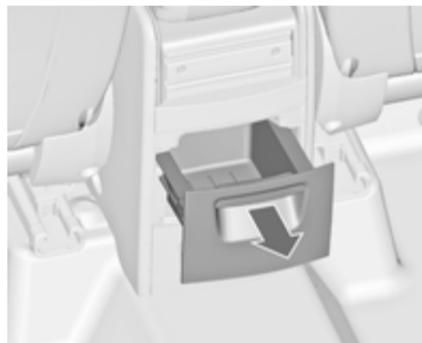
An der Rückseite der FlexConsole-Armlehne befindet sich ein Schubfach. Zum Öffnen herausziehen.
