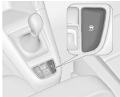
Die Traktionskontrolle kann ausgeschaltet werden, wenn ein Durchdrehen der Antriebsräder erwünscht ist: Taste
