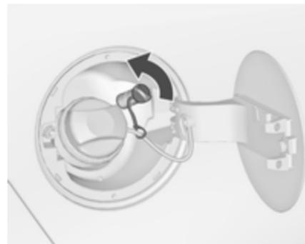
Die Schutzkappe vom Einfüllstutzen abschrauben.
