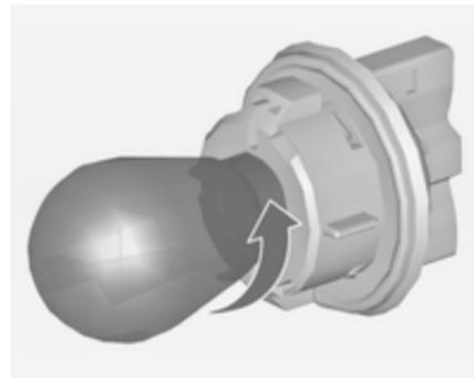
2. Lampe durch Drehen gegen den Uhrzeigersinn aus der Lampenfassung nehmen.
