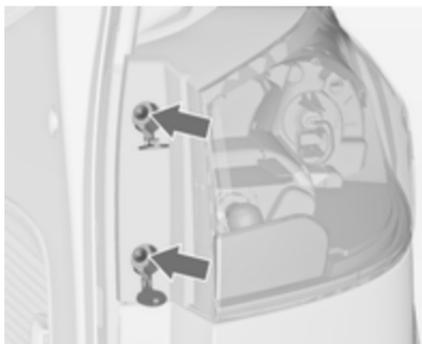
2. Die mit Pfeilen gekennzeichneten Schrauben entfernen.
