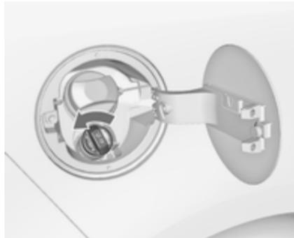
4. Die Schutzkappe vom Einfüllstutzen abschrauben.
