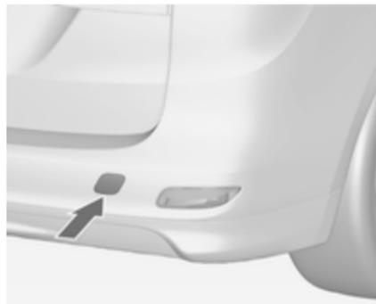
Mit einem Schraubendreher in den Schlitz an der unteren Kante der Abdeckung fahren. Abdeckung durch vorsichtiges Abwärtsbewegen des Schraubendrehers lösen. Um Schäden zu vermeiden, wird empfohlen, ein Tuch zwischen Schraubendreher und Rahmen zu legen.
