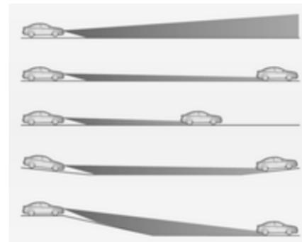
Eine spezielle topografische Bewertungsfunktion erkennt vorausfahrende Fahrzeuge an Steigungen oder Gefällen, indem es die Bewegung der Rückleuchten auswertet. Das System passt die Leuchtweitenhöhe so an, dass die Straße optimal ausgeleuchtet wird, ohne andere Verkehrsteilnehmer zu blenden.
