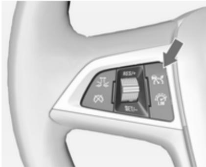
Zum Einschalten des adaptiven Geschwindigkeitsreglers Taste
