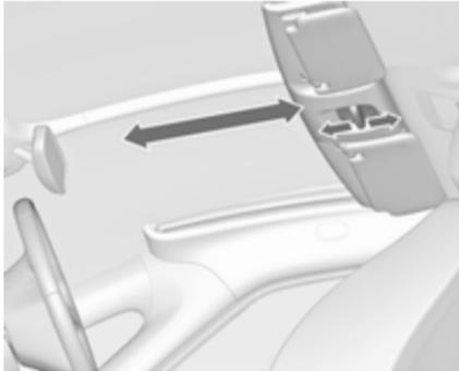
Am Schieberegler ziehen, um die Abdeckung des Panoramadachs zu öffnen.
