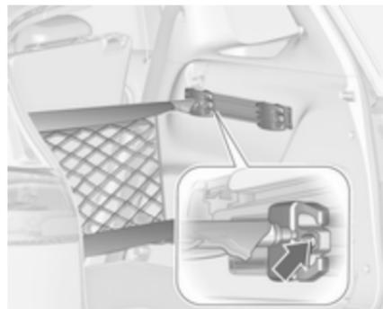
Adapter in die erforderliche Position in den Schienen einsetzen. Die Hälften der Netzstangen zusammestecken.
