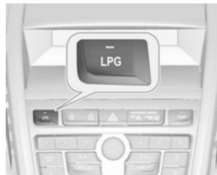
Taste **LPG** drücken, um zwischen Benzin- und Flüssiggasbetrieb umzuschalten. Die LED-Leuchte
