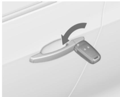
Die Fahrertür durch Drehen des Schlüssels im Schloss von Hand entriegeln. Zündung einschalten und Zentralverriegelungstaste
