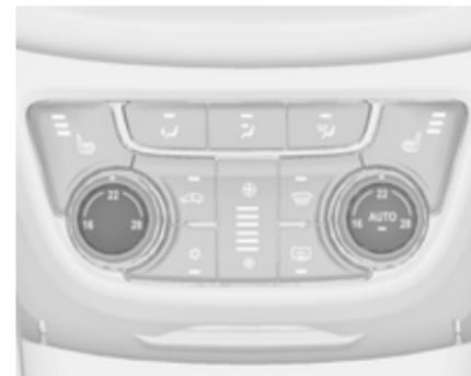
Ist die Mindesttemperatur eingestellt, läuft die Klimaanlage mit maximaler Kühlung, sofern Kühlung ☀ eingeschaltet ist.
