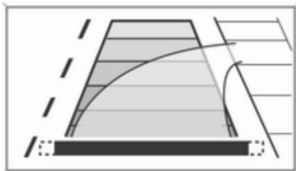
Die Fahrzeugspur wird entsprechend des Lenkwinkels angezeigt.
