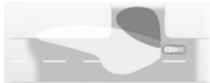
In engen Kurven oder beim Abbiegen wird abhängig vom Lenkwinkel oder dem Blinkersignal links oder rechts ein zusätzlicher Reflektor eingeschaltet, der die Straße im rechten Winkel zur Fahrtrichtung beleuchtet. Er wird bei Geschwindigkeiten von bis zu 40 km/h aktiviert.
