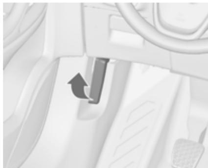
Entriegelungshebel ziehen und in die Ausgangsposition zurückführen.
