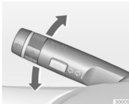
Hebel nach oben = Blinker rechts
