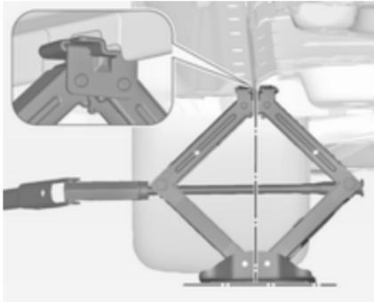
5. Wagenheber auf die erforderliche Höhe einstellen. Den Heber unmittelbar unter den Ansatzpunkt stellen und sicherstellen, dass er nicht rutschen kann.
