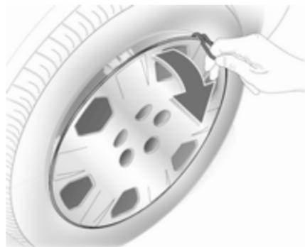
1. Radmutternkappen mit Schraubendreher lösen und abnehmen. Radabdeckung mit dem Haken abziehen. Wagenwerkzeug ↪ 253.
