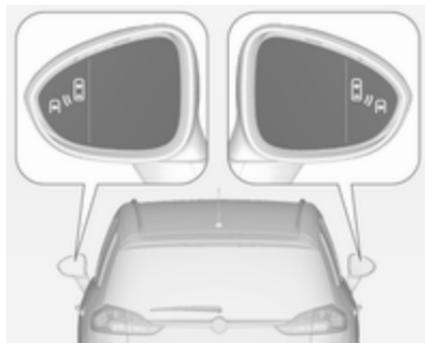
Die Funktion „Toter-Winkel-Warnung“ ist bei Geschwindigkeiten zwischen 10 km/h und 140 km/h aktiv. Bei Geschwindigkeiten über 140 km/h wird das System deaktiviert; dies wird in beiden Außenspiegeln durch die Warnsymbole  $\text{a}^{\text{a}}$  angezeigt. Wird die Geschwindigkeit erneut reduziert, erlöschen die Warnsymbole. Wird daraufhin ein Fahrzeug im toten Winkel erkannt, leuchten die Warnsymbole  $\text{a}^{\text{a}}$  wie üblich auf der entsprechenden Seite auf.
