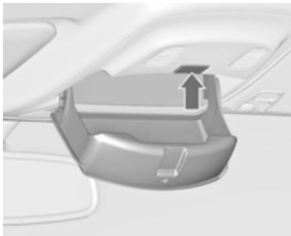
Zum Öffnen des Ablagefachs die Taste drücken.
