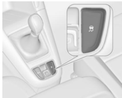
Für extremes Hochleistungsfahren kann ESC deaktiviert werden: Taste
