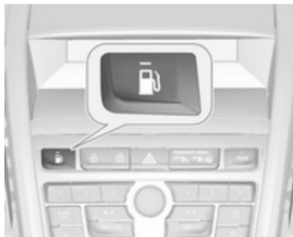
Durch Drücken der Taste
