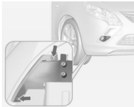
1. Die äußeren, mit Pfeilen gekennzeichneten Schrauben der Abdeckung abnehmen.
