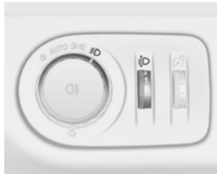
Zur Anpassung der Leuchtweite an die Fahrzeugbeladung, um Blendwirkung zu reduzieren: Daumenrad
