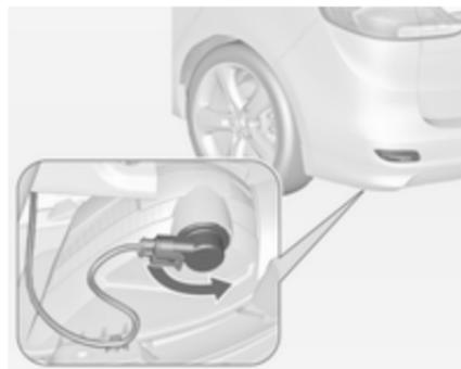
1. Die Lampenfassung nach links drehen und aus dem Reflektor herausnehmen.
