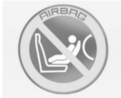
Außerdem gibt es einen Waraufkleber seitlich an der Instrumententafel, welcher bei geöffneter Beifahrertür sichtbar ist, bzw. an der Sonnenblende des Beifahrers.
