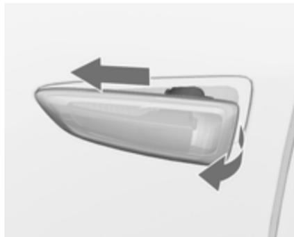
1. Auf der linken Fahrzeugseite Leuchte nach vorne schieben und das hintere Ende zuerst vom Kotflügel abnehmen.
