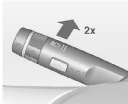
Der Fernlichtassistent wird aktiviert, wenn bei einer Geschwindigkeit über 40 km/h zweimal der Blinkerhebel gedrückt wird.
