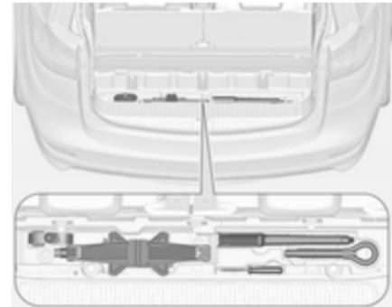
Bestimmte Werkzeuge, die Abschleppöse und (nur bei Fahrzeugen mit Reserverad) der Wagenheber befinden sich im hinteren Staufach im Laderaumboden.
