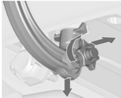
Die Schutzklappe öffnen und zum Entriegeln der Kugelstange den Schlüssel in Position
