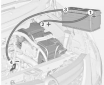
Reihenfolge für das Anschließen der Kabel:
