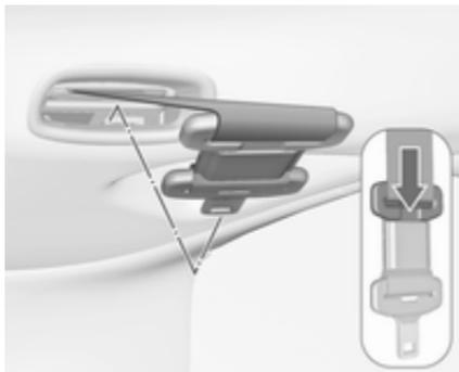
Die obere Schlosszunge in die Halterung drücken. Die zusammengesteckten Schlosszungen an den Sicherheitsgurt klappen.
