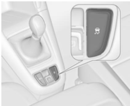
Die Traktionskontrolle kann ausgeschaltet werden, wenn ein Durchdrehen der Antriebsräder erwünscht ist: Taste
