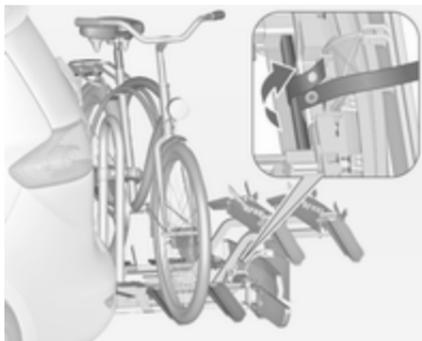
4. Den am Anbaustück befestigten Gurt unter dem Hebel durchführen, um das Heckträgersystem später nach unten klappen zu können. Den Gurt fixieren.
