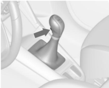
Zum Einlegen des Rückwärtsgangs nach Betätigen des Kupplungspedals bei stehendem Fahrzeug
