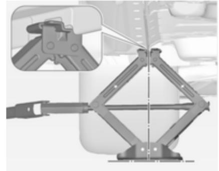
5. Wagenheber auf die erforderliche Höhe einstellen. Den Heber unmittelbar unter den Ansatzpunkt stellen und sicherstellen, dass er nicht rutschen kann.
