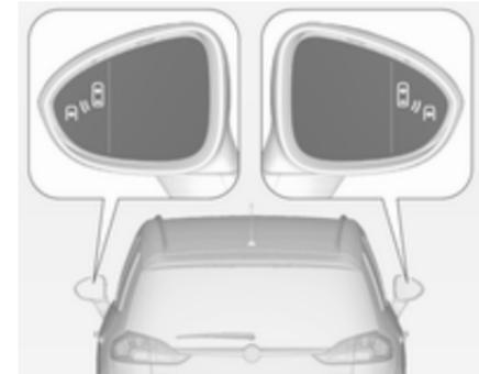
Die Funktion „Toter-Winkel-Warnung“ ist bei Geschwindigkeiten zwischen 10 km/h und 140 km/h aktiv. Bei Geschwindigkeiten über 140 km/h wird das System deaktiviert. Dies wird in beiden Außenspiegeln durch die Warnsymbole <sup>a</sup><sub>b</sub> angezeigt.
