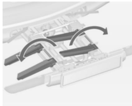
Beide Radaufnahmen ausklappen.
