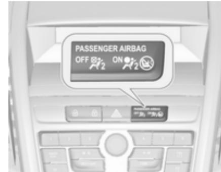
Wenn die Kontrollleuchte „ON
