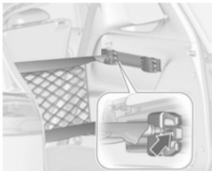
Adapter in die erforderliche Position in den Schienen einsetzen. Die Hälften der Netzstangen zusammenschieben.
