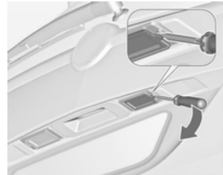
1. Schraubendreher in die Aussparung der Abdeckung einführen, zur Seite drücken und die Feder lösen. Abdeckung abnehmen.
