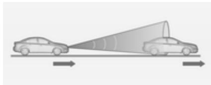
Der adaptive Geschwindigkeitsregler arbeitet mit einem Radarsensor zum Erkennen der vorausfahrenden Fahrzeuge. Wird kein Fahrzeug in der Fahrspur erkannt, arbeitet der adaptive Geschwindigkeitsregler wie ein herkömmlicher Geschwindigkeitsregler.
