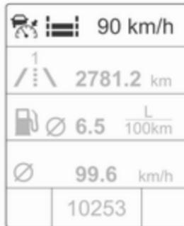
Das Symbol für den adaptiven Geschwindigkeitsregler, der eingestellte Sicherheitsabstand und die festgelegte Geschwindigkeit werden in der obersten Zeile des Driver Information Centers angezeigt.
