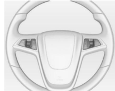
Das Infotainment-System, bestimmte Fahrerassistenzsysteme und ein angeschlossenes Mobiltelefon können mit den Lenkradelementen bedient werden.
