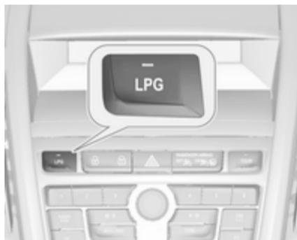
Taste **LPG** drücken, um zwischen Benzin- und Flüssiggasbetrieb umzuschalten. Die LED-Leuchte
