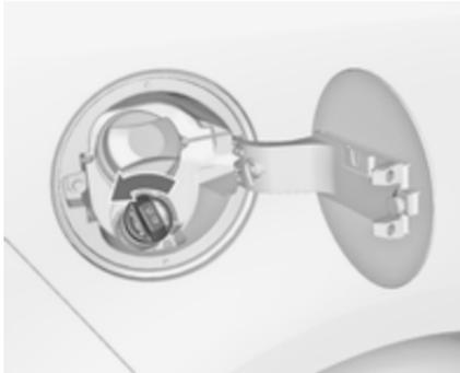
4. Die Schutzkappe vom Einfüllstutzen abschrauben.
