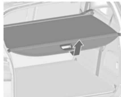
Laderaumabdeckung aus den seitlichen Halterungen nehmen. Abdeckung halten und führen, bis sie vollständig aufgerollt ist.
