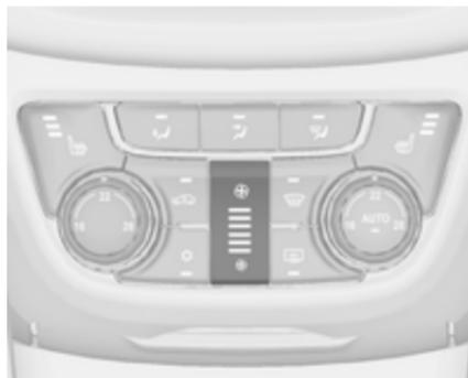
Wie abgebildet untere Taste zum Senken und obere Taste zum Erhöhen der Gebläsegeschwindigkeit drücken. Die Gebläsegeschwindigkeit ist anhand der Anzahl der Segmente auf dem Display erkennbar.
