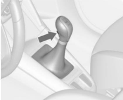
Rückwärtsgang: Nach dem Treten des Kupplungspedals bei stehendem Fahrzeug 3 Sekunden warten, dann den Knopf am Wählhebel drücken und den Gang einlegen.
