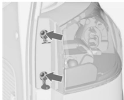
2. Die mit Pfeilen gekennzeichneten Schrauben entfernen.
