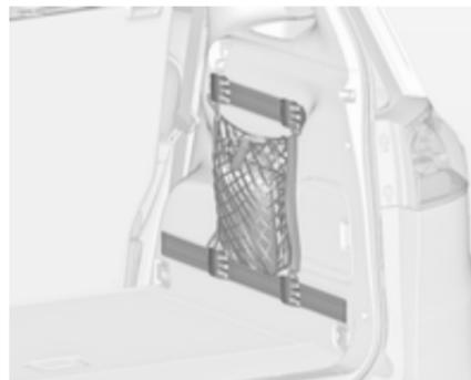
Adapter in die erforderliche Position in den Schienen einsetzen. An den Adaptern kann die Netztasche eingehängt werden.
