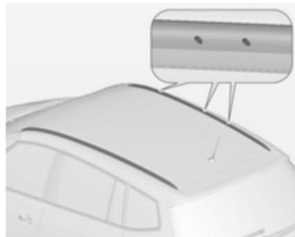
Den Dachgepäckträger im Bereich der Löcher (in der Abbildung durch die Pfeile gekennzeichnet) fixieren.
