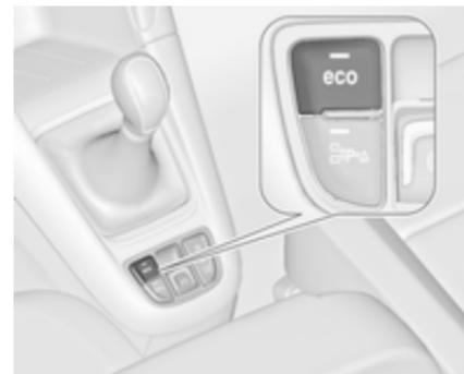
Die Stopp-Start-Automatik lässt sich durch Drücken der Taste **eco** manuell deaktivieren. Die Deaktivierung wird durch Erlöschen der LED in der Taste angezeigt.
