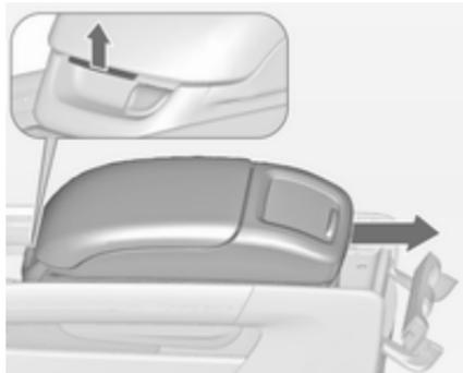
Am Griff vorne an der Armlehne ziehen und die Armlehne nach hinten aus der Konsole schieben.
