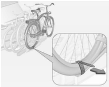
6. Beide Reifen des vierten Fahrrads mit Spannbändern zusätzlich an den Radaufnahmen sichern.
