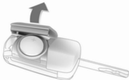
Schlüsselbart ausklappen und die Funkfernbedienung öffnen. Batterie austauschen (Batterietyp CR 2032). Die neue Batterie richtig einsetzen. Funkfernbedienung schließen und synchronisieren.
