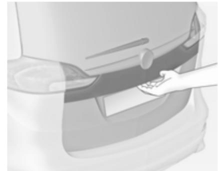
Nach dem Entriegeln den Touchpadschalter unter der Leiste der Hecktür betätigen und die Hecktür öffnen.
