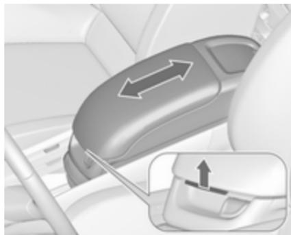
Die Armlehne kann in die Position einer Mittelkonsole verschoben werden. Am Griff ziehen, um die Armlehne zu verschieben.
