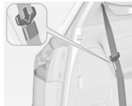
Wenn die Sicherheitsgurte nicht verwendet oder die Sitze eingeklappt werden, die Gurtzunge der beiden Sicherheitsgurte in die am Gurt angebrachte Tasche einführen.
