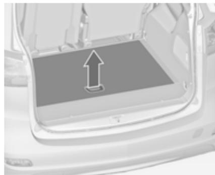
Bei Fahrzeugen ohne dritte Sitzreihe befinden sich unter der Bodenabdeckung Staufächer. Zum Öffnen die Abdeckung anheben und aufrecht hinter die Rücksitze klappen.
