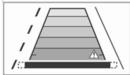
Dank der hohen Lage der Kamera wird auch der Heckstoßfänger auf dem Bild angezeigt und bietet so eine gute Orientierungsmöglichkeit.
