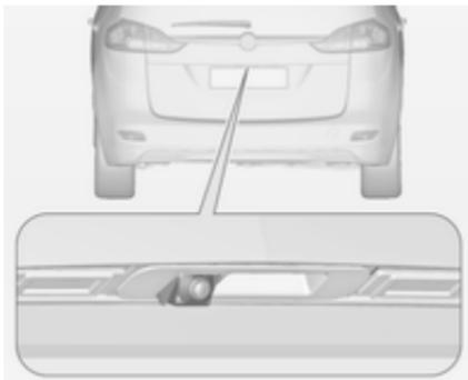
Die Kamera ist in den Hecktürgriff integriert und verfügt über einen Blickwinkel von 130°.
