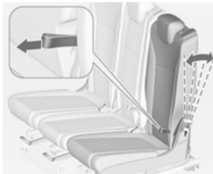
Rückenlehne in die senkrechte Position heben. Neigung durch Ziehen an der Lasche einstellen.
