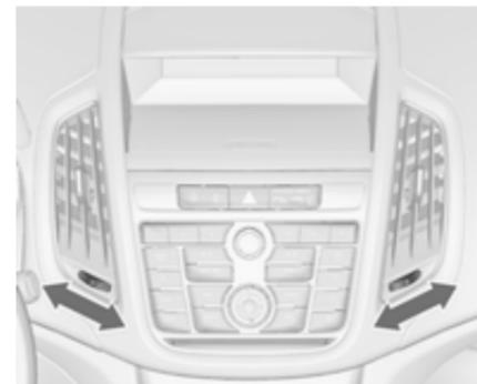
Zum Öffnen der Düse Einstellrädchen auf
