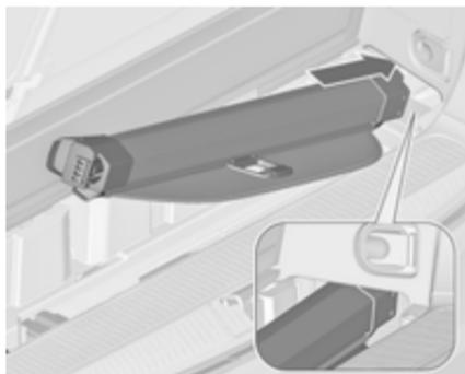
Die Abdeckung mit der Oberseite nach unten und dem Freigabehebel nach links in die Aufnahme rechts im Staufach legen.
