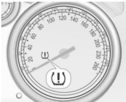
Wenn niedriger Reifendruck erkannt wird, wird dies durch die Kontrollleuchte
