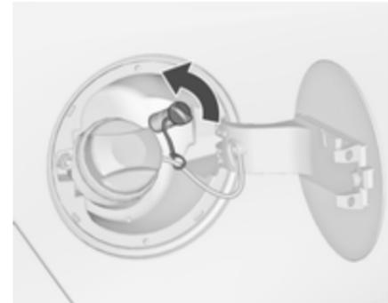
Die Schutzkappe vom Einfüllstutzen abschrauben.
