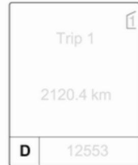
Im Getriebe-Display werden Modus oder gewählter Gang angezeigt.
