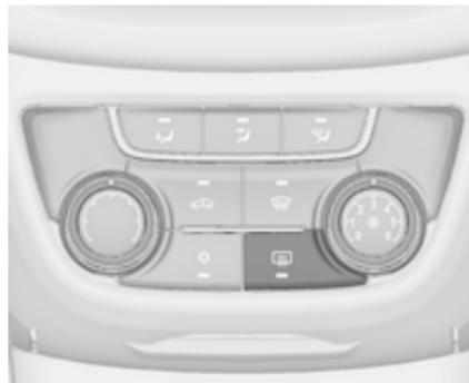
Die Heizung wird durch Drücken der Taste
