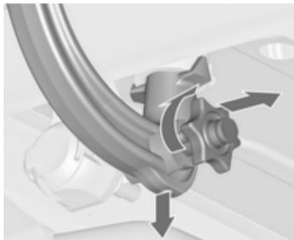
Die Schutzklappe öffnen und zum Entriegeln der Kugelstange den Schlüssel in Position
