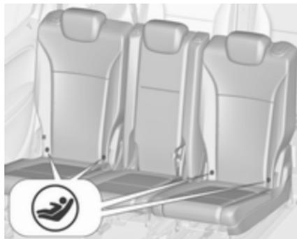
Für das Fahrzeug zugelassene ISOFIX Kindersicherheitssysteme an ISOFIX Befestigungsbügel befestigen. Die speziellen Positionen für ISOFIX Kindersicherheitssysteme sind in der Tabelle mit IL gekennzeichnet.
