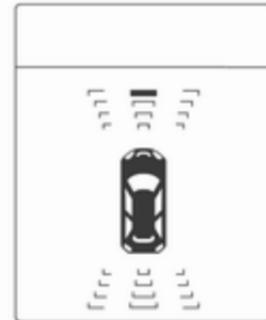
Bei Modellen mit Uplevel-Kombi-Display wird der Abstand zu einem Hindernis vor und hinter dem Fahrzeug durch veränderliche Abstandslinien rund um das Fahrzeug angezeigt.
