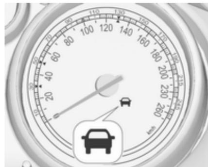
Ein Fahrzeug wird durch die Kontrollleuchte
