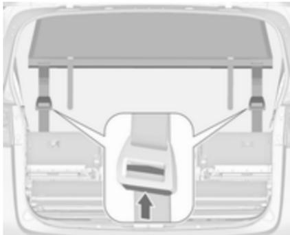
Auf beiden Seiten die Taste am Spannmittel drücken, um das Band zu lösen. Haken von den Ösen lösen. Die Sicherheitsnetzstangen aus den Halterungen im Dachrahmen aushaken. Netz einrollen und mit einem Gurt sichern.
