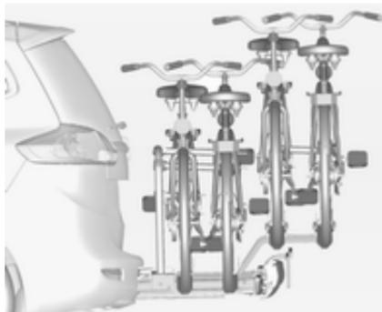
Das Heckträgersystem (Flex-Fix-System) bietet die Möglichkeit, zwei Fahrräder auf einem in den Fahrzeugboden integrierten herausziehbaren Träger zu transportieren. Auf einem Anbaustück können zwei weitere Fahrräder befestigt werden. Der Transport anderer Gegenstände ist nicht zulässig.
