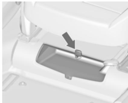
Unter dem Beifahrersitz befindet sich ein Staufach. Rollo verschieben, um das Fach zu öffnen bzw. zu schließen. Höchstlast: 1,5 kg.
