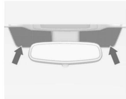
Die markierten Bereiche auf der Windschutzscheibe sind nicht beschichtet. Geräte für das Aufzeichnen von elektronischen Daten bzw. für die Gebührenbezahlung müssen in diesen Bereichen befestigt werden. Andernfalls treten möglicherweise Störungen beim Aufzeichnen der Daten auf.
