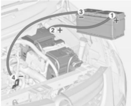
Reihenfolge für das Anschließen der Kabel:
