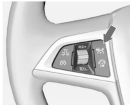
Zum Einschalten des adaptiven Geschwindigkeitsreglers Taste
