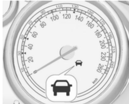
Wenn das System ein vorausfahrendes Fahrzeug in der Fahrspur erkannt hat, leuchtet die Kontrollleuchte für ein erkanntes vorausfahrendes Fahrzeug
