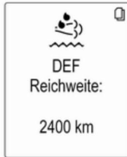
Wenn der AdBlue-Füllstand unter einen bestimmten Wert fällt, wird eine Füllstandswarnung **DEF Reichweite: 2400 km** im Driver Information Center (DIC) angezeigt.
