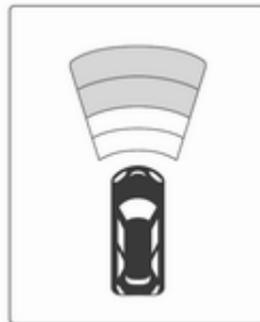
Bei Modellen mit Uplevel-Display wird der Abstand zu einem Hindernis vor dem Fahrzeug durch veränderliche Balken angezeigt.
