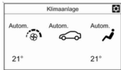
Die Klimatisierungseinstellungen sind im Graphic-Info-Display bzw. je nach Ausführung im Colour-Info-Display zu sehen. Einstellungsänderungen werden auf beiden Displays kurzzeitig über dem aktuellen Menü eingeblendet.
