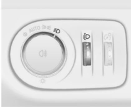
Zur Anpassung der Leuchtweite an die Fahrzeugbeladung, um Blendwirkung zu reduzieren: Daumenrad
