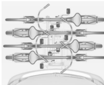
3. Die Fahrräder abwechselnd mit dem Lenker nach links bzw. rechts auf dem Heckträgersystem positionieren.
