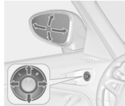
Gewünschten Außenspiegel durch Drehen des Bedienelements nach links (**L**) bzw. rechts (**R**) wählen. Danach das Bedienelement schwenken, um den Spiegel einzustellen.
