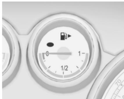
Anzeige von Kraftstofffüllstand bzw. Gasdruck im Tank je nach Betriebsart.
