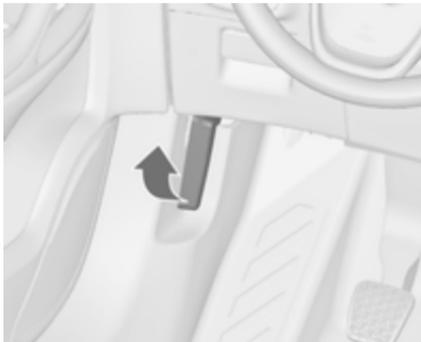
Entriegelungshebel ziehen und in die Ausgangsposition zurückführen.
