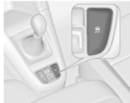
Für extremes Hochleistungsfahren kann ESC deaktiviert werden: Taste
