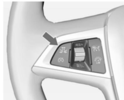
Taste ⚠️ drücken. Die aktuelle Einstellung wird im Driver Information Center angezeigt. Taste ⚠️ erneut drücken, um die Warnempfindlichkeit zu ändern. Die Einstellung wird außerdem in der obersten Zeile des Driver Information Centers angezeigt.
