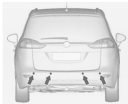
Die Front-Heck-Einparkhilfe misst die Entfernung zwischen dem Fahrzeug und Hindernissen vor und hinter dem
