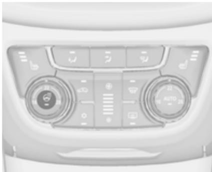
Die Heizung durch Drücken der Taste
