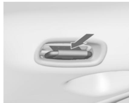
Den Sicherheitsgurthalter in das Dach schieben. Dabei muss die untere Schlosszunge nach vorn zeigen.
