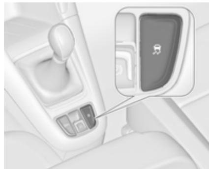
Für extremes Hochleistungsfahren kann ESC deaktiviert werden: Taste
