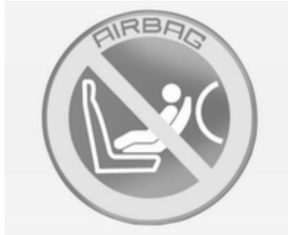
Außerdem gibt es einen Warnaufkleber seitlich an der Instrumententafel, welcher bei geöffneter Beifahrertür sichtbar ist, bzw. an der Sonnenblende des Beifahrers.
