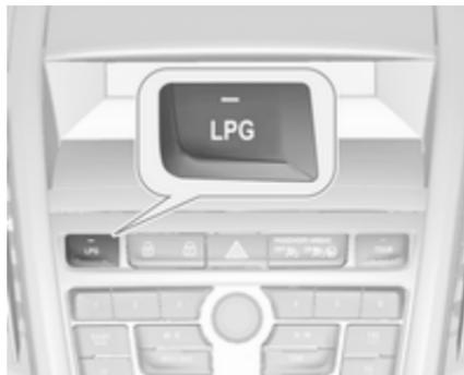
Durch Drücken der Taste **LPG** wird zwischen Benzin- und Flüssiggasbetrieb umgeschaltet, sobald die erforderlichen Parameter (Kühlmitteltemperatur, Gastemperatur und Mindest-drehzahl des Motors) erreicht sind.
