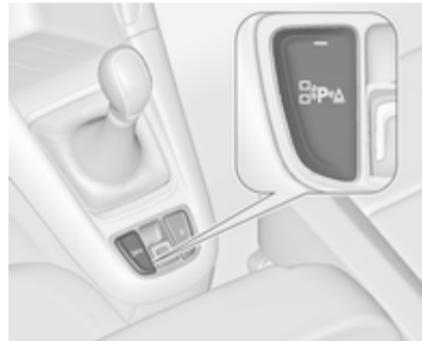
Beim Einlegen des Rückwärtsgang wird das System automatisch aktiviert.
