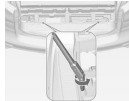
3. Radschlüssel auf eine Sechskantschraube aufsetzen und gegen den Uhrzeigersinn drehen, bis ein Widerstand bemerkbar ist.
