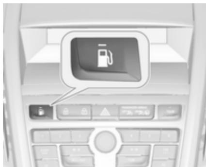
Durch Drücken der Taste
