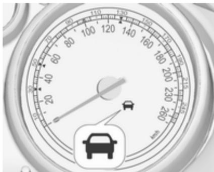
Wenn das System ein vorausfahrendes Fahrzeug in der Fahrspur erkannt hat, leuchtet die Kontrollleuchte für ein erkanntes vorausfahrendes Fahrzeug
