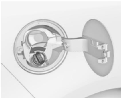
4. Die Schutzkappe vom Einfüllstutzen abschrauben.
