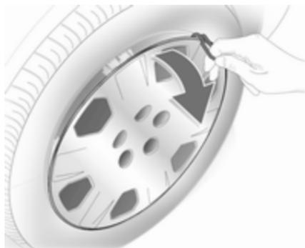
1. Radmutternkappen mit Schraubendreher lösen und abnehmen. Radabdeckung mit dem Haken abziehen. Wagenwerkzeug ⇨ 257.
