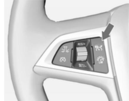
Zum Einschalten des adaptiven Geschwindigkeitsreglers Taste
