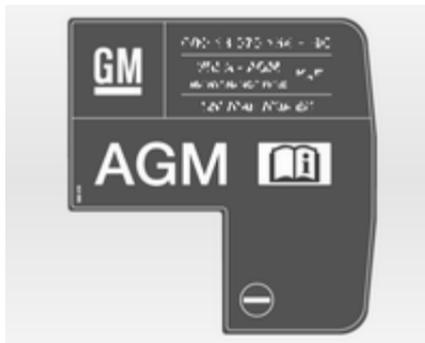
AGM-Batterien sind am entsprechenden Batterieschild zu erkennen. Wir empfehlen den Einsatz einer original Opel-Fahrzeuggbatterie.
