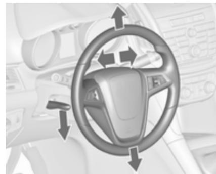
Den Griff entriegeln, das Lenkrad einstellen, den Griff einrasten und darauf achten, dass er komplett verriegelt ist.
