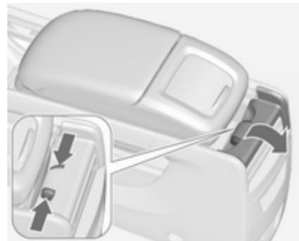
Hinten an der Armlehne die Befestigungselemente nach innen drücken und den Verriegelungsmechanismus nach unten klappen.
