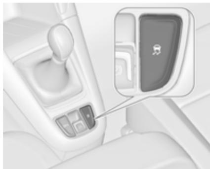
Die Traktionskontrolle kann ausgeschaltet werden, wenn ein Durchdrehen der Antriebsräder erwünscht ist: Taste
