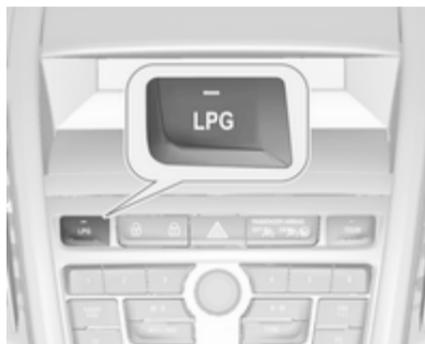
Taste **LPG** drücken, um zwischen Benzin- und Flüssiggasbetrieb umzuschalten. Die LED-Leuchte
