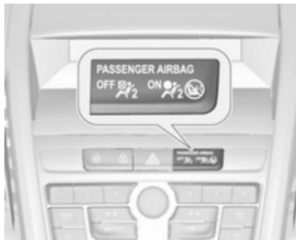
Wenn die Kontrollleuchte „ON
