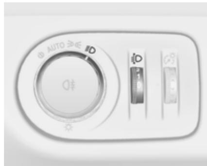
Zur Anpassung der Leuchtweite an die Fahrzeugbeladung, um Blendwirkung zu reduzieren: Daumenrad
