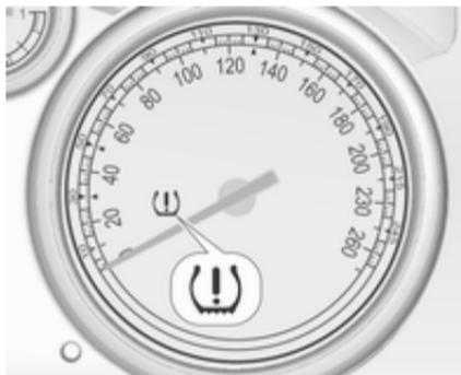
Wenn niedriger Reifendruck erkannt wird, wird dies durch die Kontrollleuchte
