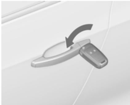
Die Fahrertür durch Drehen des Schlüssels im Schloss von Hand entriegeln. Zündung einschalten und
