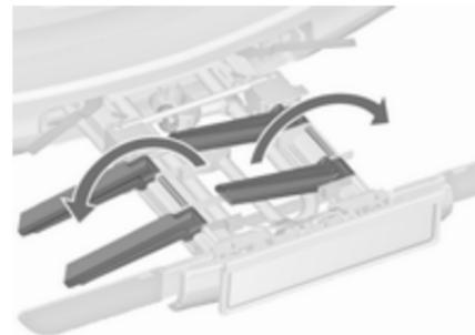
Beide Radaufnahmen ausklappen.
