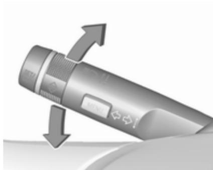
Hebel nach oben = Blinker rechts
