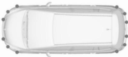
Die erweiterte Einparkhilfe führt den Fahrer durch Anweisungen im Fahrerinformationszentrum und akustische Signale in eine Parklücke. Der Fahrer muss selbst beschleunigen, bremsen, lenken und schalten.
