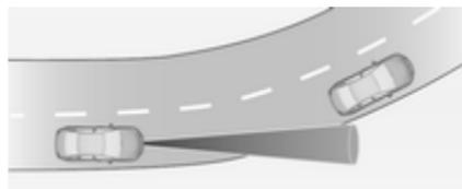
Ausgehend von der Zentrifugalkraft berechnet der adaptive Geschwindigkeitsregler einen voraussichtlichen Weg. Der berechnete Weg berücksichtigt die aktuellen Kurveigenschaften, kann jedoch keine späteren Änderungen der Kurvenspur vorhersehen. Das System kann daher ein vorausfahrendes Fahrzeug aus dem Erkennungsbereich verlieren oder ein Fahrzeug erkennen das sich nicht auf der verwendeten Fahrspur befindet. Dies kann beim Einfahren in eine Kurve oder beim Ausfahren aus einer
