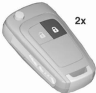
🔒 auf der Funkfernbedienung zweimal innerhalb von 15 Sekunden drücken.
