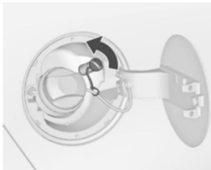
Die Schutzkappe vom Einfüllstutzen abschrauben.
