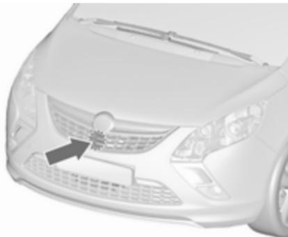
Das Radargerät ist hinter dem Kühlergrill unterhalb des Markenemblems montiert.
