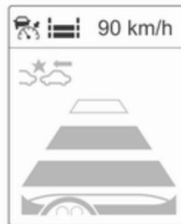
Beachten Sie, dass die Einstellung der Warnempfindlichkeit mit der Abstandswarnung des adaptiven Geschwindigkeitsreglers zusammenhängt. Durch Ändern der Warnempfindlichkeit wird auch die Einstellung der Abstandswarnung des adaptiven Geschwindigkeitsreglers geändert.
