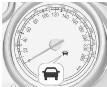
Wenn das System ein vorausfahrendes Fahrzeug in der Fahrspur erkannt hat, leuchtet die Kontrollleuchte für ein erkanntes vorausfahrendes Fahrzeug
