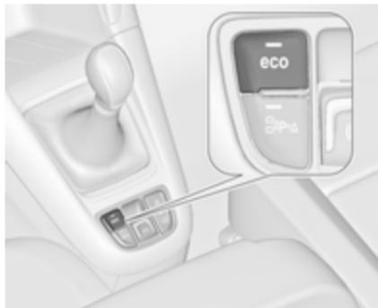
Die Stopp-Start-Automatik lässt sich durch Drücken von **eco** manuell deaktivieren. Die Deaktivierung wird durch Erlöschen der LED in der Taste angezeigt.
