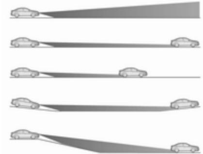
Eine spezielle topografische Bewertungsfunktion erkennt vorausfahrende Fahrzeuge an Steigungen oder Gefällen, indem es die Bewegung der Rückleuchten auswertet. Das System passt die Leuchtweitenhöhe so an, dass die Straße optimal ausgeleuchtet wird, ohne andere Verkehrsteilnehmer zu blenden.
