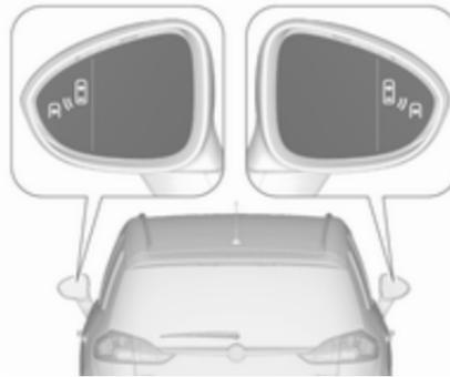
Die Funktion „Toter-Winkel-Warnung“ ist bei Geschwindigkeiten zwischen 10 km/h und 140 km/h aktiv. Bei Geschwindigkeiten über 140 km/h wird das System deaktiviert.
