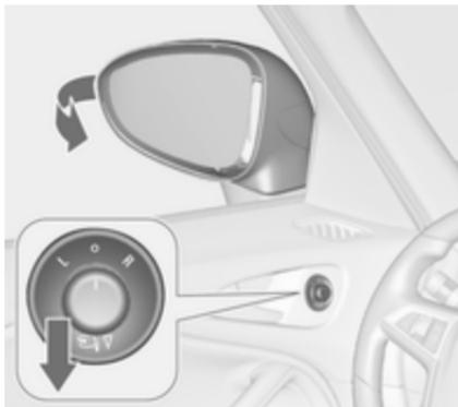
Bedienelement auf **0** drehen und dann hinunterdrücken. Beide Außenspiegel werden eingeklappt.
