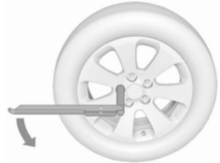
2. Radschraubenschlüssel herausklappen und sicherstellen, dass er gut sitzt. Jede Radmutter um eine halbe Drehung lösen.
