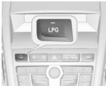
**LPG** drücken, um zwischen Benzin- und Flüssiggasbetrieb umzuschalten. Die LED-Leuchte
