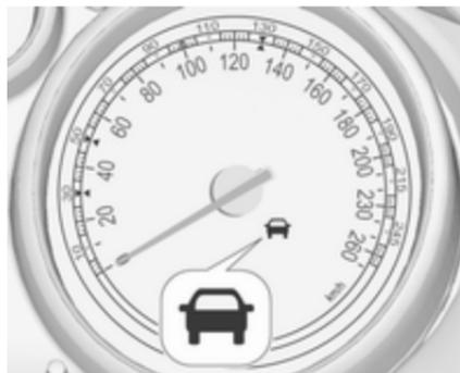
Ein Fahrzeug wird durch die Kontrollleuchte
