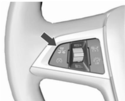
Das ACC-Symbol drücken. Die aktuelle Einstellung wird im Driver Information Center angezeigt. Das ACC-Symbol erneut drücken, um den Sicherheitsabstand zu ändern. Die Einstellung wird außerdem in der obersten Zeile des Driver Information Centers angezeigt.
