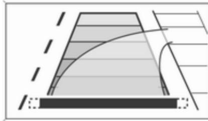
Die Fahrzeugspur wird entsprechend des Lenkwinkels angezeigt.
