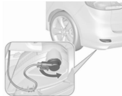
1. Die Lampenfassung nach links drehen und aus dem Reflektor herausnehmen.
