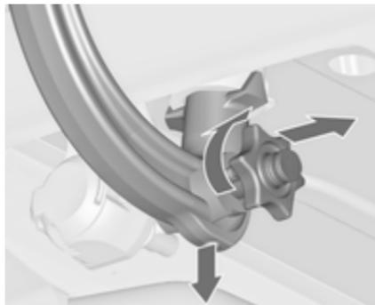
Die Schutzklappe öffnen und zum Entriegeln der Kugelstange den Schlüssel in Position
