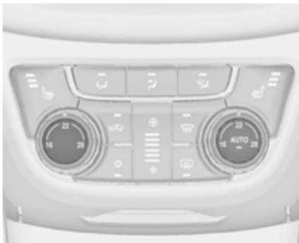
Ist die Mindesttemperatur **Lo** eingestellt, läuft die Klimaanlage mit maximaler Kühlung, sofern die Kühlung
