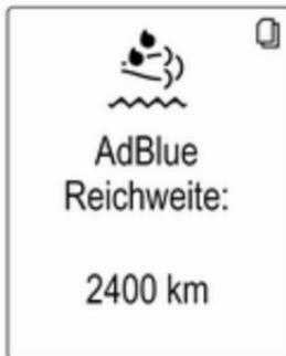
Wenn der AdBlue-Füllstand unter einen bestimmten Wert fällt, wird eine Füllstandswarnung **AdBlue Reichweite: 2400 km** im Driver Information Center angezeigt.
