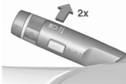
Durch zweimaliges Drücken des Blinkerhebels werden die intelligente Leuchtweitenregulierung und das automatische Fernlicht eingeschaltet. Sie können bei eingeschalteter Zündung eingeschaltet werden.
