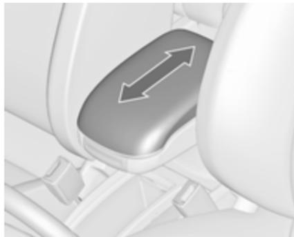
Die Armlehnenkonsole enthält ein Ablagefach. Zum Öffnen die Armlehne nach vorne schieben.
