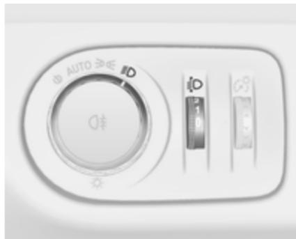
Zur Anpassung der Leuchtweite an die Fahrzeugbeladung, um Blendwirkung zu reduzieren: Daumenrad  $\text{D}$  in die gewünschte Stellung drehen.
