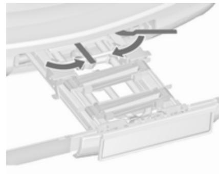
Die beiden Spannhebel so weit wie möglich nach innen schwenken.
