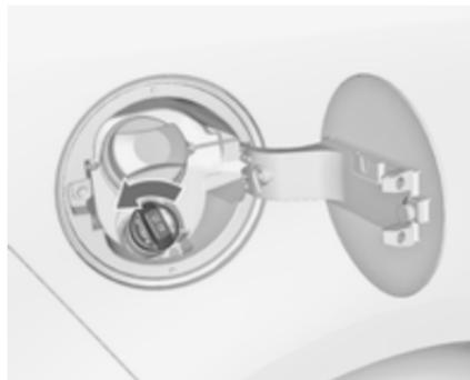
4. Die Schutzkappe vom Einfüllstutzen abschrauben.
