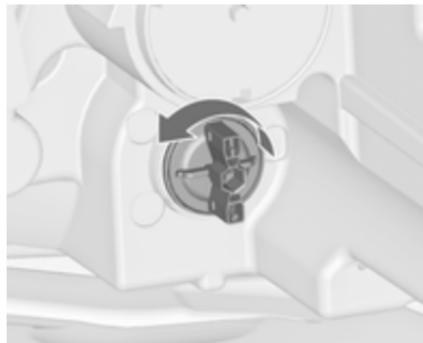
1. Lampenfassung (2) durch Drehen nach links austrasten. Lampenfassung aus dem Reflektor ziehen.
