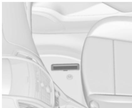
Die Fahrzeug-Identifizierungsnummer ist eventuell in das Typschild und das Bodenblech unter der Bodenabdeckung eingestanzt, erkennbar unter einer Abdeckung.
