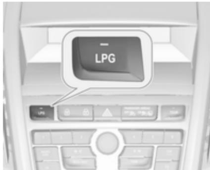
Durch Drücken von **LPG** wird zwischen Benzin- und Flüssiggasbetrieb umgeschaltet, sobald die erforderlichen Parameter (Kühlmitteltempera-
