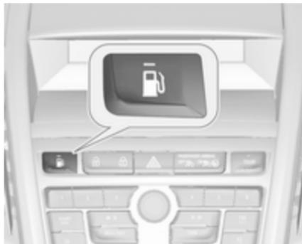
Durch Drücken von
