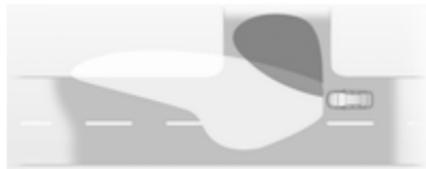
In engen Kurven oder beim Abbiegen wird abhängig vom Lenkwinkel oder dem Blinkersignal links oder rechts ein zusätzlicher Reflektor eingeschaltet, der die Straße im rechten Winkel
