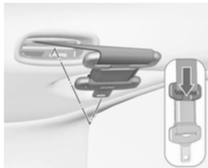
Die obere Schlosszunge in die Halterung drücken. Die zusammengesetzten Schlosszungen an den Sicherheitsgurt klappen.
