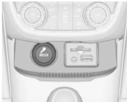
Der Zigarettenanzünder befindet sich in der vorderen Konsole. Die Abdeckung nach unten klappen.
