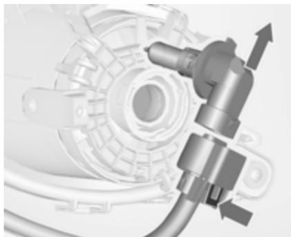
3. Die Lampenfassung durch Drücken der Haltnase vom Stecker lösen.
