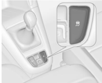
Für extremes Hochleistungsfahren kann ESC deaktiviert werden:
