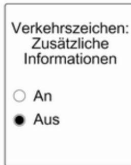
Sobald die Einstellungsseite angezeigt wird, die Popup-Funktion durch Auswahl von **Aus** deaktivieren. Durch Auswahl von **An** wird sie wieder eingeschaltet. Beim Einschalten der Zündung wird die Popup-Funktion ausgeschaltet.
