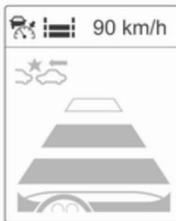
Der ausgewählte Sicherheitsabstand wird durch ausgefüllte Abstandsbalken auf der Seite des adaptiven Geschwindigkeitsreglers angezeigt.
