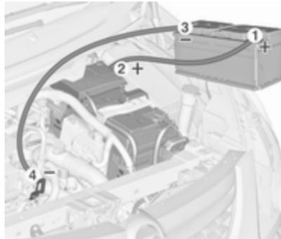
Reihenfolge für das Anschließen der Kabel:
