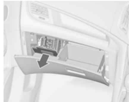
In Rechtslenkern befindet sich der Sicherungskasten hinter einer Abdeckung im Handschuhfach. Das Handschuhfach öffnen, dann die Abdeckung öffnen und nach unten klappen.
