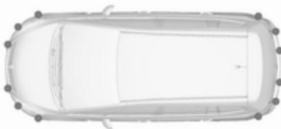
Die erweiterte Einparkhilfe führt den Fahrer durch Anweisungen im Driver Information Center und akustische
