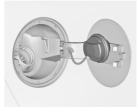
Der Tankdeckel kann in die Halterung auf der Tankklappe eingehängt werden.
