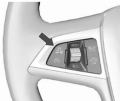
$\text{Radar}$  drücken; die aktuelle Einstellung wird im Driver Information Center angezeigt.  $\text{Radar}$  erneut drücken, um die Warnempfindlichkeit zu ändern. Die Einstellung wird außerdem in der obersten Zeile des Driver Information Centers angezeigt.
