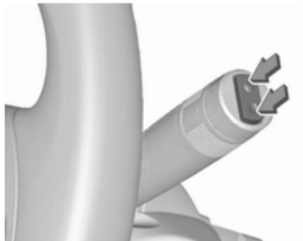
Zur Betätigung des Heckscheibenwischers Wippschalter drücken:
