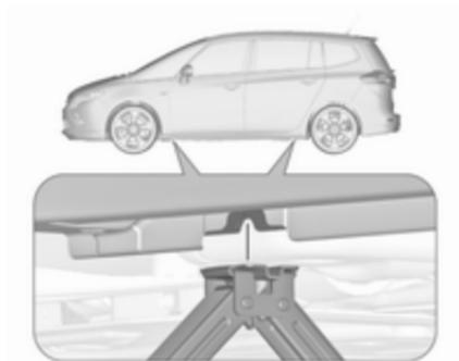
4. Sicherstellen, dass der Wagenheber richtig unter dem entsprechenden Ansatzpunkt ausgerichtet ist.
