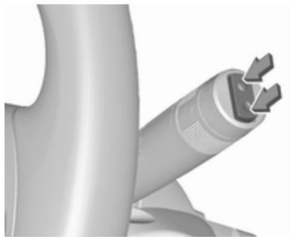
Zur Betätigung des Heckscheibenwischers Wippschalter drücken:
