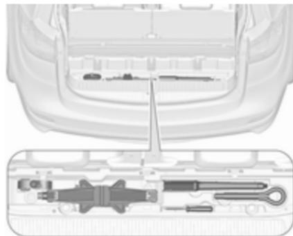
Bestimmte Werkzeuge, die Abschleppöse und (nur bei Fahrzeugen mit Reserverad) der Wagenheber befinden sich im hinteren Staufach im Laderaumboden.
