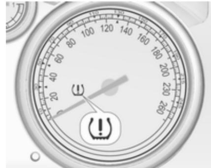
Wenn niedriger Reifendruck erkannt wird, wird dies durch die Kontrollleuchte
