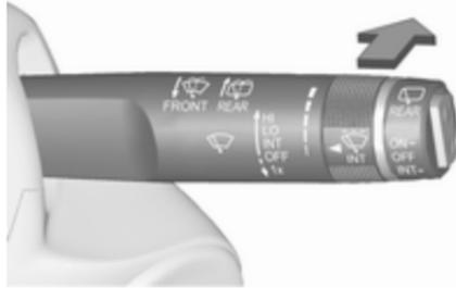
Hebel drücken. Waschflüssigkeit spritzt auf die Heckscheibe und der Wischer wird für einige Wischbewegungen eingeschaltet.
