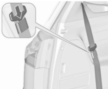
Vor dem Bedienen der Laderaumabdeckung die Gurtzungen der beiden Sicherheitsgurte in die am Gurt angebrachte Tasche einführen.
