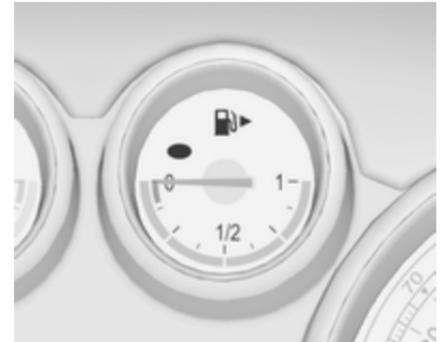
Anzeige von Kraftstofffüllstand bzw. Gasdruck im Tank je nach Betriebsart.
