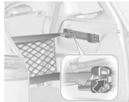
Adapter in die erforderliche Position in den Schienen einsetzen. Die Hälften der Netzstangen zusammensetzen.
