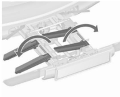
Beide Radaufnahmen ausklappen.
