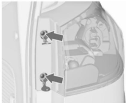
2. Die mit Pfeilen gekennzeichneten Schrauben entfernen.
