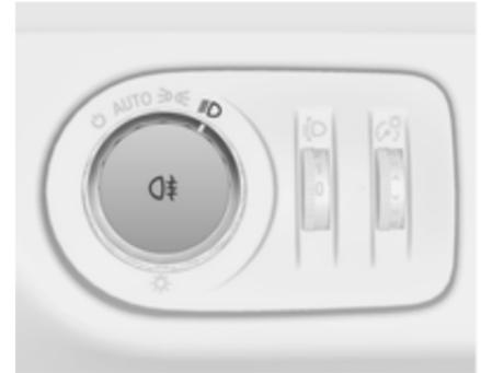
Wird durch Drücken von  $\text{☉}$  bedient. Lichtschalter in Stellung **AUTO**: Beim Einschalten der Nebelschlussleuchte werden die Scheinwerfer automatisch eingeschaltet.
