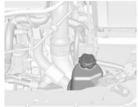
Der Stand der Lenkunterstützungsflüssigkeit muss im Allgemeinen nicht geprüft werden. Wenn beim Lenken ungewöhnliche Geräusche auftreten oder die Lenkunterstützung eine unerwartete Reaktion aufweist, die Hilfe einer Werkstatt in Anspruch nehmen.
