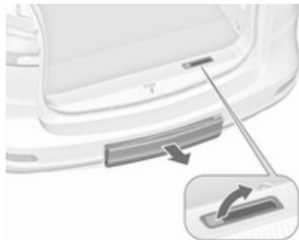
Den Entriegelungshebel nach oben ziehen. Das Heckträgersystem rastet aus und fährt schnell aus dem hinteren Stoßfänger.
