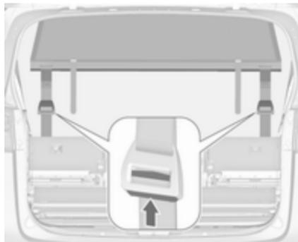
Auf beiden Seiten die Taste am Spannmechanismus drücken, um das Band zu lösen. Haken von den Ösen lösen. Die Sicherheitsnetzstangen aus den Halterungen im Dachrahmen aushaken. Netz einrollen und mit einem Gurt sichern.
