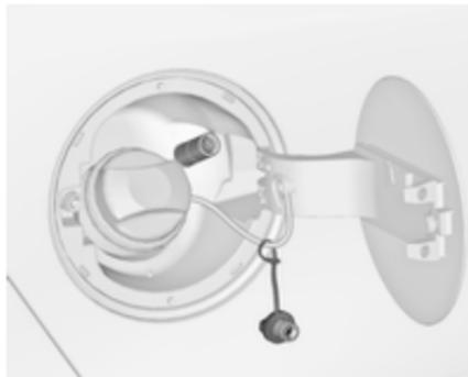
Den erforderlichen Adapter handfest auf den Einfüllstutzen schrauben.
