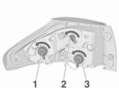
5. Lampe durch Drehen an der Lampenfassung entfernen und austauschen.
