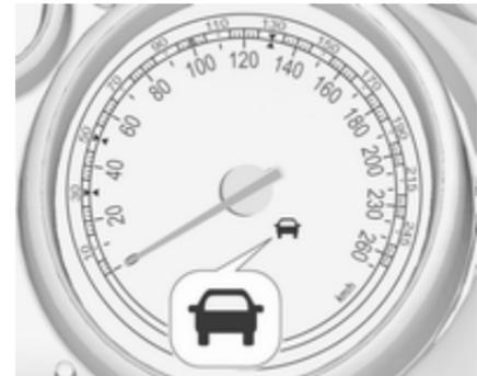
Wenn das System ein vorausfahrendes Fahrzeug in der Fahrspur erkannt hat, leuchtet die Kontrollleuchte für ein erkanntes vorausfahrendes Fahrzeug
