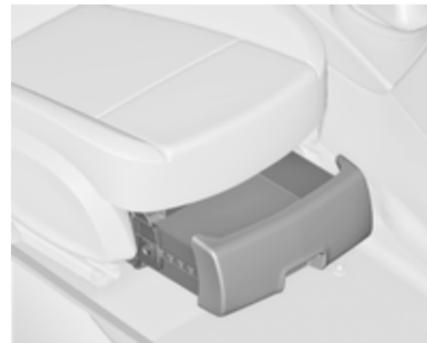
Knopf in der Mulde drücken und Lade herausziehen. Maximale Belastung: 3 kg. Zum Schließen hineindrücken und einrasten.
