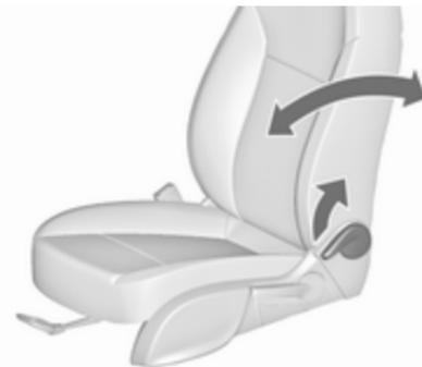
Hebel ziehen, Neigung einstellen und Hebel loslassen. Die Rückenlehne muss hörbar einrasten.
