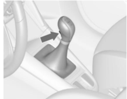
Zum Einlegen des Rückwärtsgangs bei stehendem Fahrzeug das Kupplungspedal treten, den Entriegelungsknopf am Wählhebel drücken und Gang einlegen.
