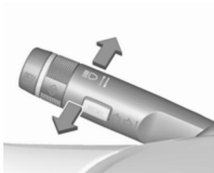
Zum Umschalten von Ablendlicht auf Fernlicht Hebel nach vorne drücken.
