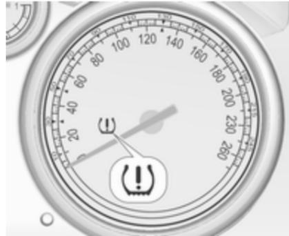
Wenn niedriger Reifendruck erkannt wird, wird dies durch die Kontrollleuchte (⚠) gemeldet ⇨ 118.
