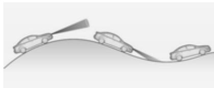
Die Systemleistung beim Bergauf- und Bergabfahren und beim Ziehen eines Anhängers ist abhängig von der Fahrgeschwindigkeit, der Beladung, den Verkehrsbedingungen und der
