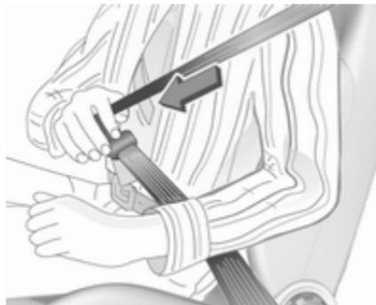
Den Gurt aus dem Aufroller herausziehen, unverdreht über den Körper legen und die Schlosszunge in das Gurtschloss einstecken, bis sie einrastet. Den Beckengurt während der Fahrt durch Ziehen am Schultergurt regelmäßig spannen.
