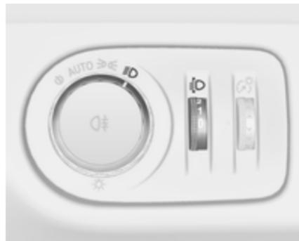
Zur Anpassung der Leuchtweite an die Fahrzeugbelastung, um Blendwirkung zu reduzieren: Daumenrad  $\text{D}$  in die gewünschte Stellung drehen.
