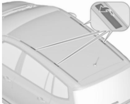
Zur Befestigung eines Dachgepäckträgers die Kappen in den Dachleisten öffnen. Die Befestigungsvorrichtungen nach Anweisung in die in der Abbildung dargestellte Halterung einführen.
