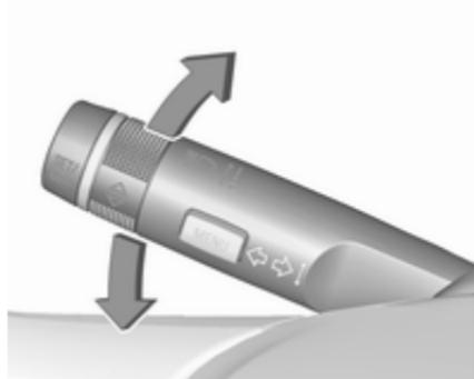
Hebel nach oben : Blinker rechts
