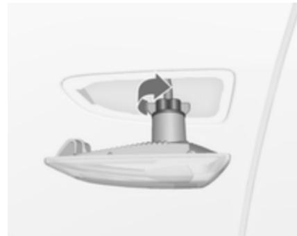
2. Lampenfassung nach links drehen, um sie aus dem Gehäuse zu entfernen.
