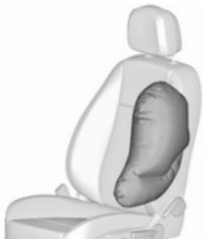
Der aufgeblähte Airbag dämpft den Aufprall, wodurch die Verletzungsgefahr für Oberkörper und Becken bei einem Seitenaufprall deutlich verringert wird.
