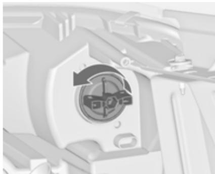
1. Lampenfassung (3) durch Drehen nach links ausrasten. Lampenfassung aus dem Reflektor ziehen.
