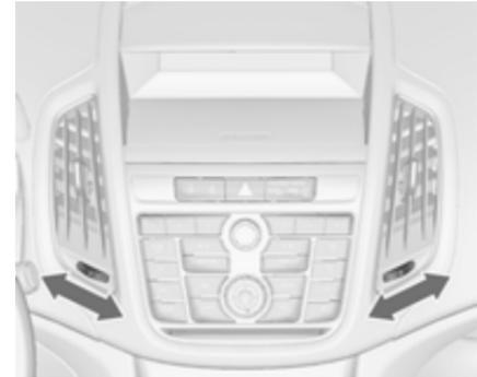
Zum Öffnen der Düse Einstellrädchen auf I drehen. Durch Drehen am Einstellrad die Luftmenge an der Düse einstellen.
