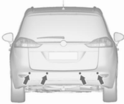
Das System besteht aus jeweils vier Ultraschall-Parksensoren im vorderen und hinteren Stoßfänger.
