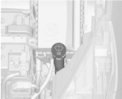
Mit einem Gemisch aus sauberem Wasser und einer geeigneten Menge zugelasener Frostschutzmittelhaltiger Scheibenwaschflüssigkeit auffüllen.
