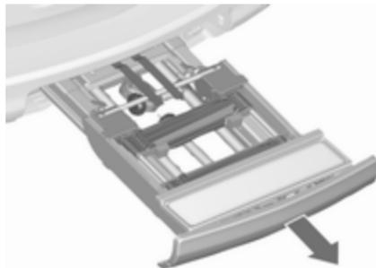
Das Heckträgersystem vollständig bis zum hörbaren Einrasten herausziehen.
