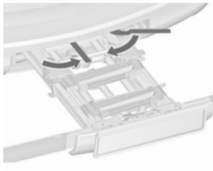
Die beiden Spannhebel so weit wie möglich nach innen schwenken.
