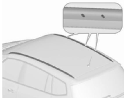
Den Dachgepäckträger im Bereich der Löcher (in der Abbildung durch die Pfeile gekennzeichnet) fixieren.
