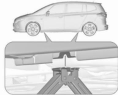
4. Sicherstellen, dass der Wagenheber richtig unter dem entsprechenden Ansatzpunkt ausgerichtet ist.
