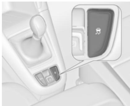
Für extremes Hochleistungsfahren kann ESC deaktiviert werden:
