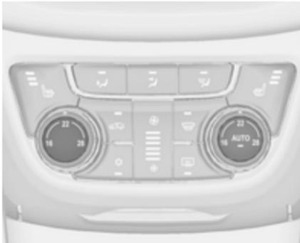
Ist die Mindesttemperatur **Lo** eingestellt, läuft die Klimaanlage mit maximaler Kühlung, sofern die Kühlung
