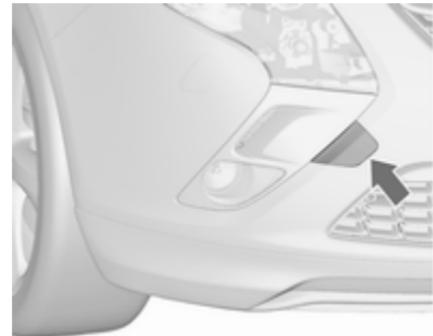
Mit einem Schraubendreher in den Schlitz an der kürzeren Kante der Abdeckung fahren. Abdeckung durch vorsichtiges Seitwärtsbewegen des Schraubendrehers lösen. Um Schäden zu vermeiden, wird empfohlen, ein Tuch zwischen Schraubendreher und Rahmen zu legen.
