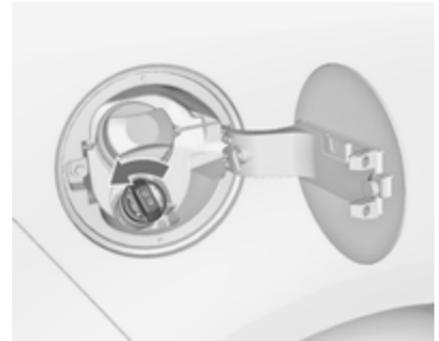
4. Die Schutzkappe vom Einfüllstutzen abschrauben.
