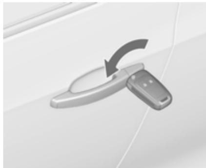
Die Fahrertür durch Drehen des Schlüssels im Schloss von Hand entriegeln. Zündung einschalten und
