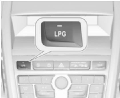
Durch Drücken von **LPG** wird zwischen Benzin- und Flüssiggasbetrieb umgeschaltet, sobald die erforderlichen Parameter (Kühlmitteltemperatur, Gastemperatur und Mindestdrehzahl des Motors) erreicht sind. Die Anforderungen sind normalerweise nach etwa 60 Sekunden (je nach Außentemperatur) und der ersten festen Betätigung des Gaspedals erreicht. Die LED-Statusleuchte zeigt den aktuellen Betriebsmodus.
