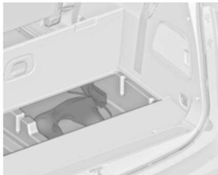
Bei Fahrzeugen ohne dritte Sitzreihe befinden sich unter der Bodenabdeckung Staufächer. Zum Öffnen die Abdeckung anheben.
