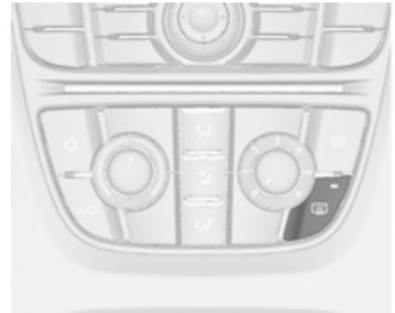
Wird durch Drücken von
