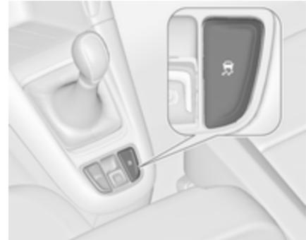
Die Traktionskontrolle kann ausgeschaltet werden, wenn ein Durchdrehen der Antriebsräder erwünscht ist:
