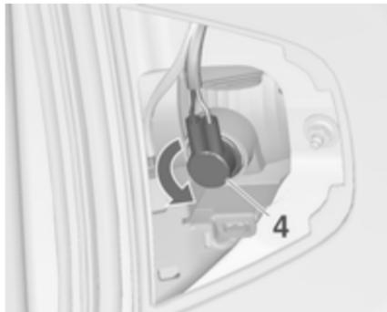
2. Die Lampenfassung nach links drehen und aus dem Reflektor herausnehmen.
