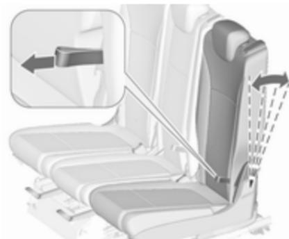
An der Schlaufe ziehen, die Neigung einstellen, die Schlaufe loslassen und die Rückenlehne einrasten lassen.
