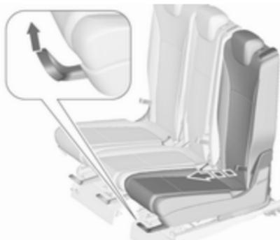
Bei der Verwendung von ISOFIX-Kindersicherheits-systemen auf der zweiten Sitzreihe empfehlen wir, den entsprechenden äußeren Sitz in die dritte Rastposition vor der hintersten Position einzustellen (Standardsitz). Der Komfortsitz, sofern ausgestattet, muss sich in der normalen Position befinden ⇨ 44.
