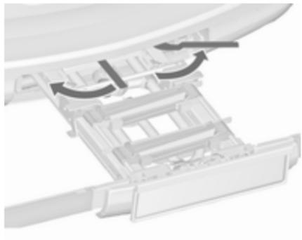
Die beiden Spannhebel so weit wie möglich zur Seite schwenken.
