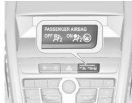
Wenn die Kontrollleuchte „ON
