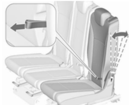
Die Rückenlehne in die senkrechte Position heben. Die Neigung durch Ziehen an der Schlaufe einstellen.
