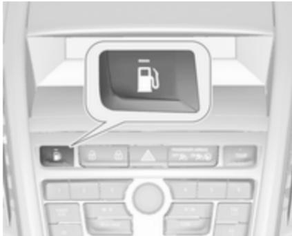
Durch Drücken von
