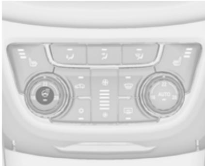
Die Heizung durch Drücken von
