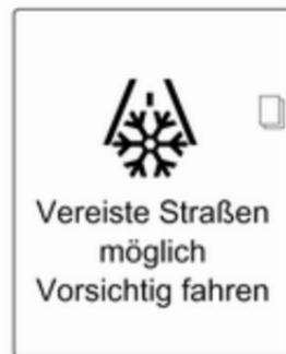
Wenn die Außentemperatur unter 3 °C sinkt, wird im Driver Information Center mit Uplevel-Kombi-Display eine Warnmeldung angezeigt.
