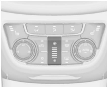
Wie abgebildet die untere Taste zum Senken und die obere Taste zum Erhöhen der Gebläsedrehzahl drücken. Die Gebläsegeschwindigkeit ist anhand der Anzahl der Segmente auf dem Display erkennbar.
