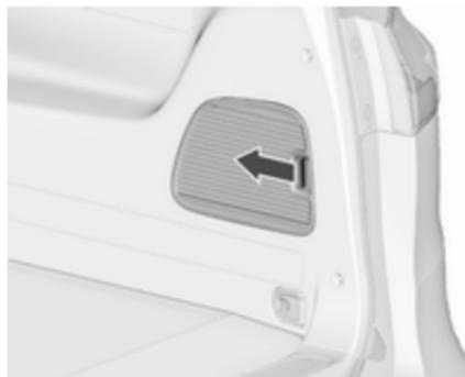
Zum Öffnen die Abdeckung in der Seitenverkleidung lösen und herausnehmen.
