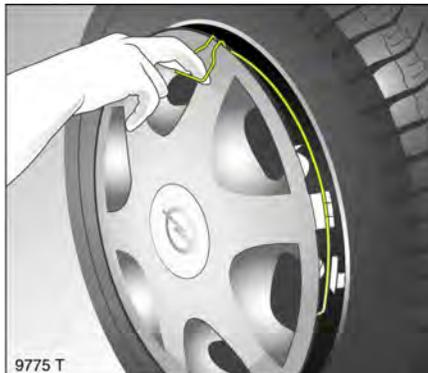
1. Radabdeckung \* mit im Wagenwerkzeug liegendem Haken \* abziehen.
