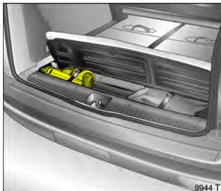
Zum Öffnen der Klappe, Teppichboden anheben, Lasche hochstellen, drehen und hochziehen.
