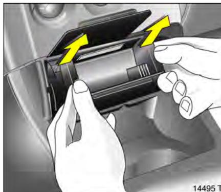
Zum Entleeren Einsatz beidseitig fassen und nach oben herausziehen.
