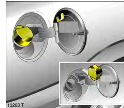
2. Nach dem automatischen Abschalten wird der Nenninhalt des Kraftstofftanks durch zweimaliges, dosiertes Nachtanken erreicht. Kraftstoffpistole dabei bis zum Anschlag einhängen.
