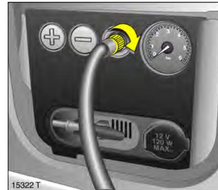
6. Luftschlauch an den Anschluss am Kompressor schrauben.
