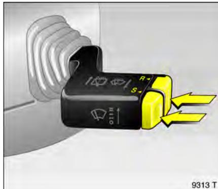
**Bedienung mit Tasten am Wischerhebel**
