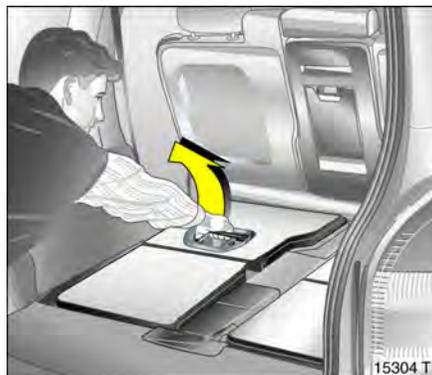
Vom Gepäckraum aus Sitz mit einer Hand am Griff hochziehen, nach hinten schwenken und bis zum hörbaren Einrasten aufrichten. Dabei mit der anderen Hand die Lehne oben abstützen, siehe Bild 15305 T.
