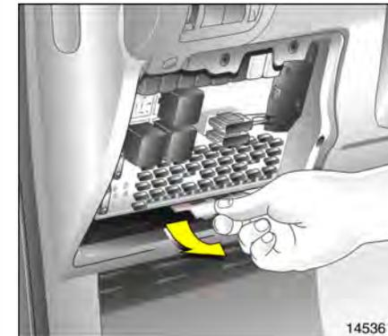
Zum Auswechseln einer Sicherung Sicherungskasten von unten her mit Griff ausrasten und vorschwenken.
