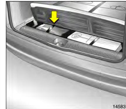
Bei Ausführung mit Anhängerzugvorrichtung Wagenheber und Wagenwerkzeug zusammen mit Warndreieck rechts im Ablagefach festschnallen.
