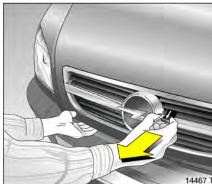
Im Kühlergrill befindet sich rechts von der Mitte – von vorn gesehen – eine Entriegelungslasche: Ziehen und Haube öffnen.
