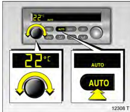
**Automatikbetrieb der Klimatisierungsautomatik \* einstellen:
