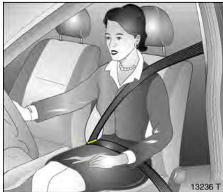
Höhenverstellung so einstellen, dass der Gurt über die Schulter verläuft und an der Schulter anliegt. Er darf nicht über Hals oder Oberarm verlaufen.
