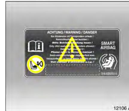
Außerdem sind Fahrzeuge mit Sitzbelegungserkennung am Aufkleber am Beifahrersitz erkennbar, siehe Bild 12106 A.
