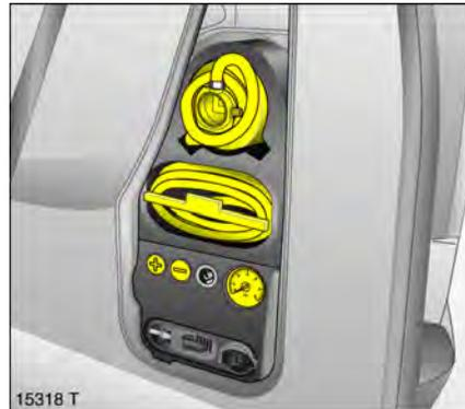
Das Reifenreparaturset befindet sich hinter einer Abdeckung rechts in der Seitenverkleidung im Gepäckraum.
