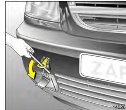
Abschleppöse links herum einschrauben und mit Radschraubensteckschlüssel bis zum Anschlag in waagerechte Stellung festdrehen.
