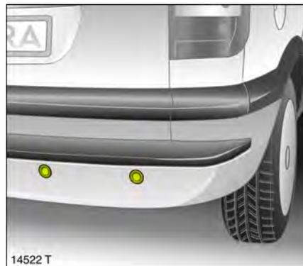
Das System erfasst den Abstand über vier Sensoren im hinteren Stoßfänger. Zur Vermeidung von Funktionsstörungen oder Fehlinformationen müssen die Sensoren unbeschädigt und frei von Verschmutzungen sowie Schnee und Eis sein.
