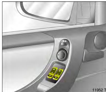
Für schrittweise Betätigung Tasten antippen. Für automatisches Öffnen oder Schließen Tasten länger drücken; zum Stoppen der Bewegung Taste nochmals antippen.
