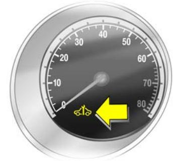
Leuchtet die Kontrollleuchte
