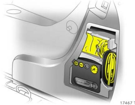
1. Dichtmittelflasche und Halter mit Luftschlauch aus dem Fach nehmen.
