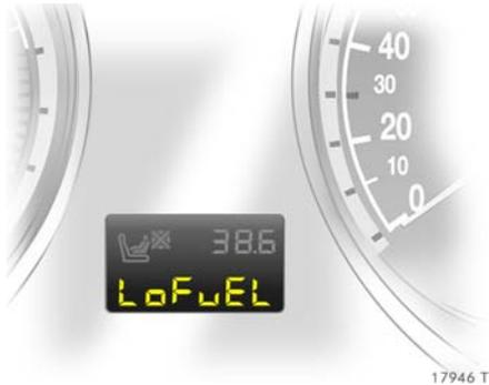
**Display im Kilometerzähler bei Erdgasbetrieb \***
