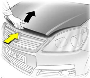
An der Motorhaubenunterseite befindet sich ein Sicherungsgriff: Hochdrücken und Haube öffnen.
