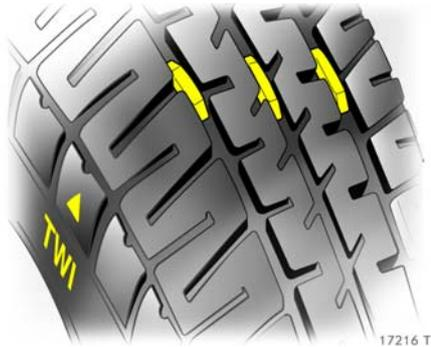
Die gesetzlich zulässige Mindestprofiltiefe (1,6 mm) ist erreicht, wenn das Profil bis zu einem Verschleißanzeiger (TWI<sup>1)</sup>) abgefahren ist. Mehrere Verschleißanzeiger sind in gleichen Abständen im Profilgrund der Lauffläche verteilt. Ihre Lage ist durch Markierungen an der Reifenflanke angezeigt.
