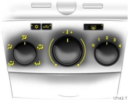
Tasten für Kühlung \* und Umluftsystem \* sind nur bei Ausführung mit optionaler Klimaanlage \* vorhanden.
