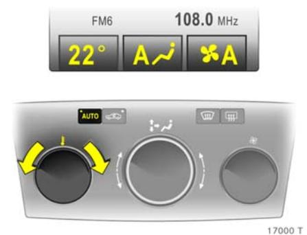
**Automatikbetrieb der Klimatisierungsautomatik \* einstellen:**
