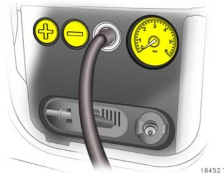
9. Taste **+** am Kompressor drücken, der Reifen wird mit dem Dichtmittel gefüllt.
