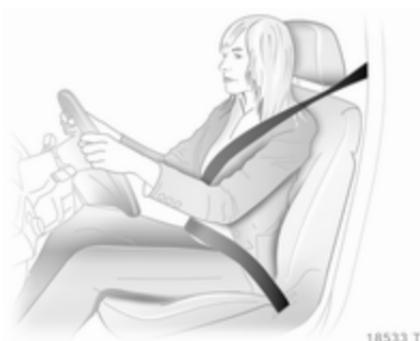
Sicherheitsgurt herausziehen und im Gurtschloss einrasten. Der Sicherheitsgurt muss unverdreht und eng am Körper anliegen. Die Rückenlehne darf nicht zu weit nach hinten geneigt sein (maximal ca. 25°).
