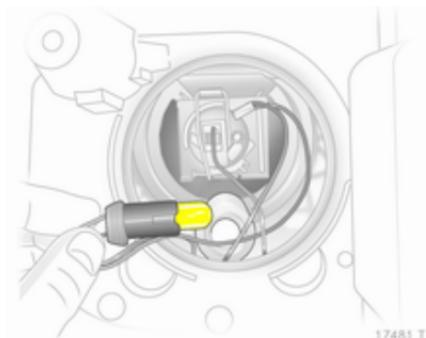
4. Glühlampe aus der Fassung nehmen und neue Glühlampe einsetzen.
