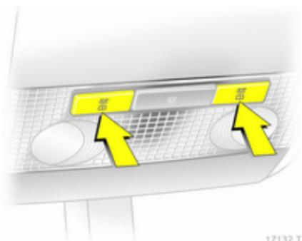
Betätigung mit Tasten bzw. mit Schalter (I = ein, 0 = aus, Mittelstellung = automatisch).
