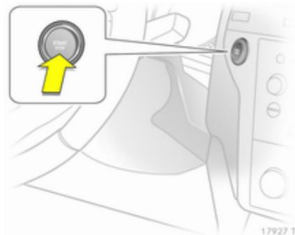
Taste **Start/Stop** drücken. Die Zündung schaltet sich ein. Wegfahrsperrung und Lenksperrung werden deaktiviert.
