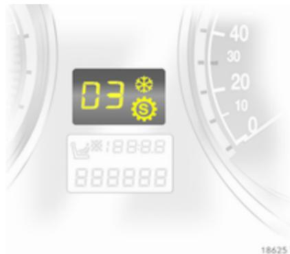
Im Getriebe-Display werden Modus oder gewählter Gang angezeigt.
