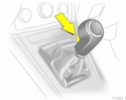
Zum Einlegen des Rückwärtsgangs bei stehendem Fahrzeug nach dem Auskuppeln 3 Sekunden warten. Anschließend Entriegelungsknopf am Wählhebel drücken und Gang einlegen.
