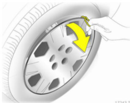
1. Radabdeckung mit dem Haken abziehen. Wagenwerkzeug ⇨ 177.
