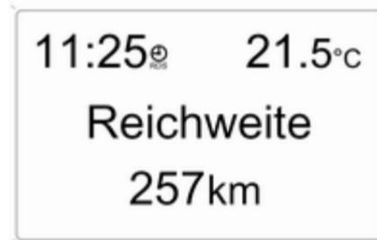
Die Reichweite wird aus dem momentanen Tankinhalt und dem Momentanverbrauch errechnet. Die Anzeige erfolgt mit gemittelten Werten.
