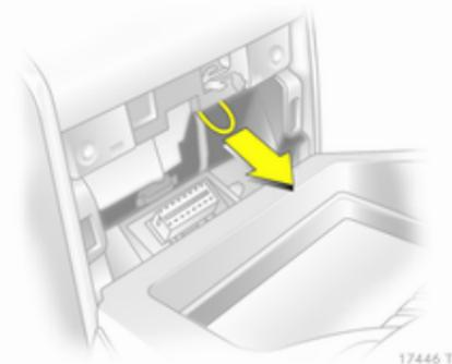
4. Schlaufe ziehen und Wählhebel aus Stellung **P** oder **N** bewegen. Wenn **P** oder **N** wieder eingelegt wird, ist der Wählhebel in der Position wieder gesperrt. Ursache der Stromunterbrechung von einer Werkstatt beheben lassen.
