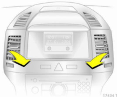
Zum Öffnen oder Schließen der Belüftungsdüse das Rändelrad drehen.
