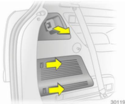
Zum Lampenwechsel auf der linken Seite Aufnahme der Laderaumabdeckung abziehen und seitliche Abdeckung öffnen: Sperrungen nach vorn drücken und Abdeckung abnehmen.
