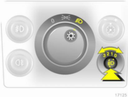
Leuchtweite der Fahrzeugbeladung anpassen, um das Blenden anderer zu vermeiden: Knopf durch Druck lösen und auf gewünschte Position drehen.
