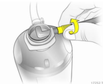
2. Luftschlauch vom Halter abwickeln und an den Anschluss der Dichtmittelflasche schrauben.
