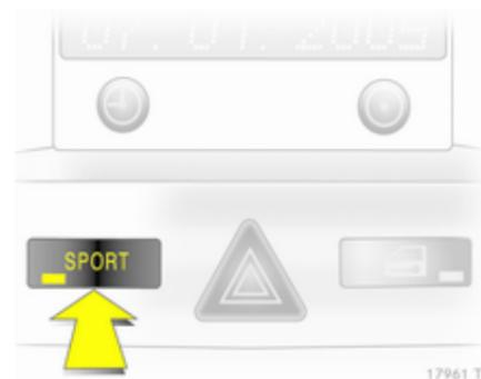
Das ESP®Plus kann ausgeschaltet werden, wenn der Sport-Modus für sportliches Fahren gewählt wird:
