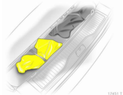
Der Beutel mit der Kugelstange ist mit einem Gummiband festgeschnallt.
