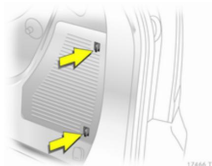
Zum Lampenwechsel auf der rechten Seite seitliche Abdeckung öffnen: Sperrungen nach vorn drücken und Abdeckung abnehmen.
