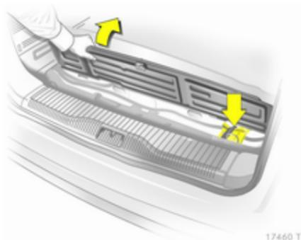
Wagenheber und Wagenwerkzeug sind in einer Tasche im Ablagefach im Boden des Laderaums mit einem Gummireifen festgeschnallt.
