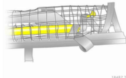
Obere Netzstange bis etwas über die Mitte nach unten rollen.
