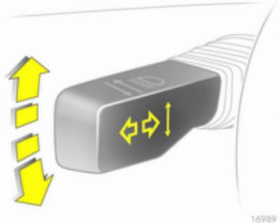
Hebel nach oben = Blinker rechts
