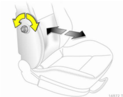
Handrad drehen. Zum Einstellen Rückenlehne entlasten.
