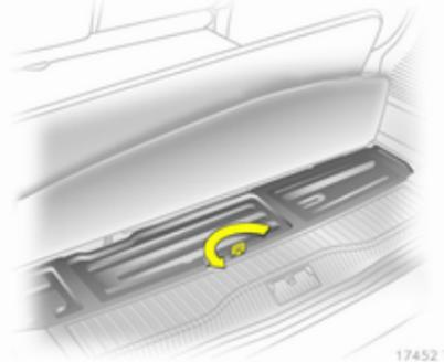
Zum Öffnen der Abdeckung Teppichboden anheben. Lasche hochstellen, drehen und hochziehen.
