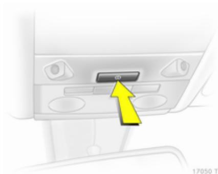
Die Überwachung der Fahrgastzelle und der Fahrzeugneigung abschalten, wenn Haustiere im Fahrzeug zurückbleiben, da der Alarm durch laute Ultraschallsignale oder Bewegungen ausgelöst werden kann. Ebenfalls abschalten, wenn sich das Fahrzeug auf einer Fähre oder einem Autoreisezug befindet.
