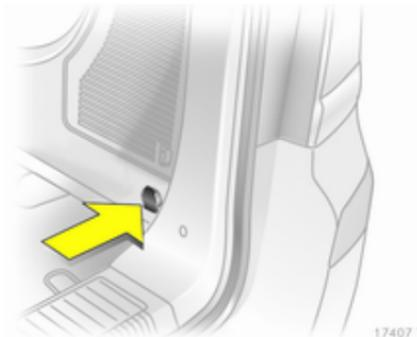
Steckdosen nicht durch ungeeignete Stecker beschädigen. Bei Anschluss von elektrischem Zubehör in Fahrzeugen mit stehendem Motor wird die Batterie entladen. Die maximale Leistungsaufnahme darf 120 Watt nicht überschreiten. Kein Strom abgeben des Zubehör wie z. B. Ladegeräte oder Batterien anschließen.
