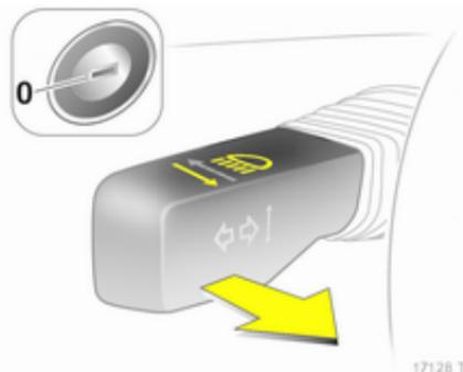
Scheinwerfer und Rückfahrlicht schalten sich nach Aktivierung des Systems und Schließen der Fahrertür für ca. 30 Sekunden ein.
