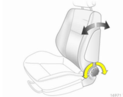
Handrad drehen. Zum Einstellen Rückenlehne entlasten.
