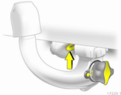
Kugelstange verriegeln, dazu Schlüssel in Position (2) drehen Schlüssel abziehen und Schutzklappe schließen.
