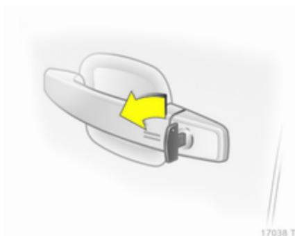
Mit dem Notschlüssel kann nur die Fahrertür verriegelt und entriegelt werden. Gesamtes Fahrzeug entriegeln ↷ 31. Bei Fahrzeugen mit Diebstahlwarnanlage kann es vorkommen, dass der Alarm beim Entriegeln des Fahrzeugs ausgelöst wird. Zur Deaktivierung Zündung einschalten.
