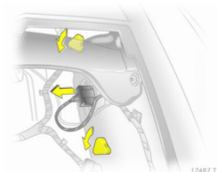
1. Stecker zusammendrücken und von dem Lampenträger abziehen.
