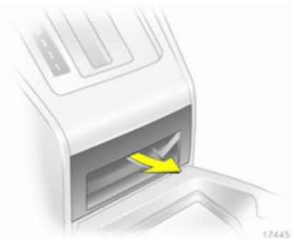
2. Aschereinsatz herausnehmen ⇨ 84. Schraube an Metallabdeckung lösen und beide Teile abnehmen. Wagenwerkzeug ⇨ 177.
