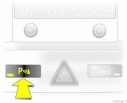
Bei Einlegen des Rückwärtsgangs schaltet sich das System automatisch ein.
