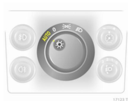
Lichtschalter in Stellung **AUTO**: Bei laufendem Motor werden die Scheinwerfer eingeschaltet, wenn das Umgebungslicht zu schwach ist.
