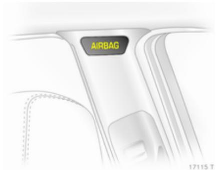
Das Kopf-Airbag-System besteht aus je einem Airbag an jeder Seite des Dachrahmens. Diese Stellen sind durch das Wort **AIRBAG** an der Dachsäule gekennzeichnet.
