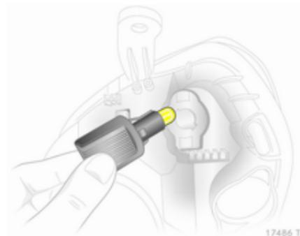
3. Glühlampe etwas in die Fassung hineindrücken, links herumdrehen und herausnehmen. Neue Glühlampe einsetzen.
