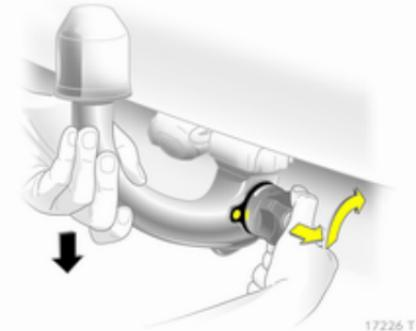
Schutzlasche öffnen und zum Entriegeln der Kugelstange Schlüssel in Position (1) drehen.
