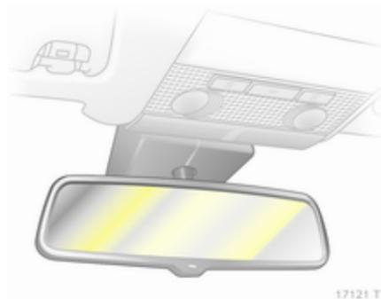
Bei Nacht wird die Blendwirkung durch nachfolgende Fahrzeuge automatisch reduziert.
