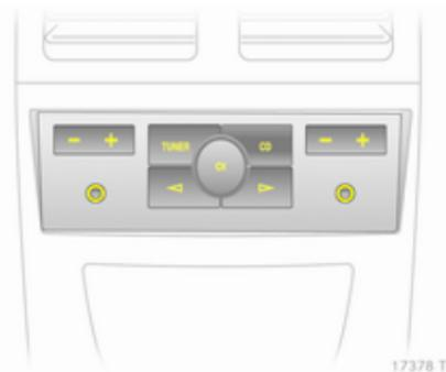
Twin Audio bietet die Möglichkeit, sowohl die am Infotainmentsystem eingestellte als auch eine andere Audioquelle wiederzugeben. Angesteuert werden kann nur die Audioquelle, die am Infotainmentsystem gerade nicht aktiv ist.
