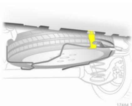
11. Sechskantschraube im Staufach mit dem Radschraubenschlüssel rechts herumdrehen.
