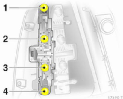
5. Glühlampe etwas in die Fassung hineindrücken, links herumdrehen und herausnehmen. Neue Glühlampe einsetzen.
