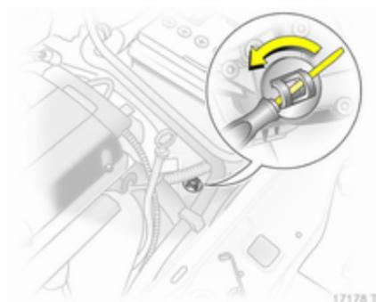
5. Mit Schlitzschraubendreher die unter dem Verschlussdeckel befindliche Stellschraube rechts herum drehen, bis ein deutlicher Widerstand spürbar ist. Die Kuppelung ist nun gelöst.
