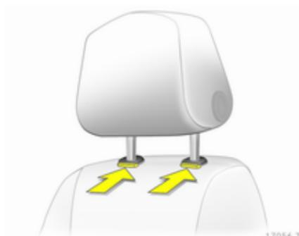
Auf die Rastfedern drücken und die Kopfstütze nach oben ziehen.
