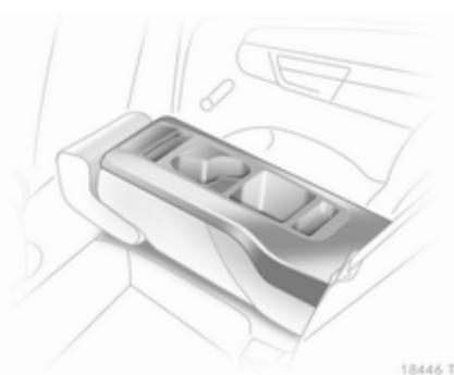
Die mittlere Rückenlehne kann heruntergeklappt als Armlehne genutzt werden und enthält Getränkehalter und Ablagefächer.
