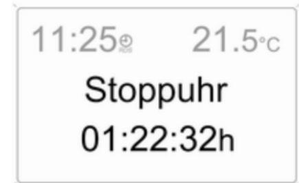
Funktion auswählen. Durch Drücken der Taste **OK** oder des linken Stellrads am Lenkrad wird die Stoppuhr gestartet oder gestoppt.
