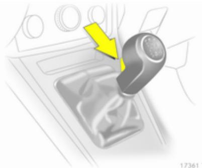
Rückwärtsgang: Bei stehendem Fahrzeug das Kupplungspedal durchtreten und 3 Sekunden lang warten. Anschließend den Entriegelungsknopf am Wählhebel betätigen und den Gang einlegen.
