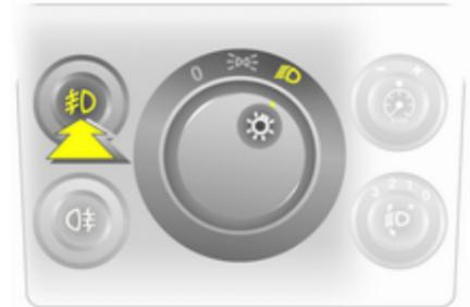
Die Nebelscheinwerfer lassen sich nur bei eingeschalteter Zündung und eingeschalteten Scheinwerfern oder Seitenleuchten einschalten.
