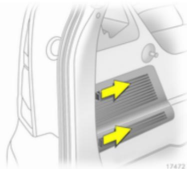
Der Sicherungskasten befindet sich hinter einer Abdeckung. Sperrungen nach vorn drücken und Abdeckung abnehmen.
