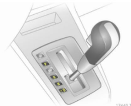
Der Wählhebel kann nur bei eingeschalteter Zündung und betätigter Fußbremse aus Stellung **P** oder **N** bewegt werden (Wählhebelsperre). Bei Wählhebel in Stellung **N** wird die Wählhebelsperre zeitverzögert und nur bei stehendem Fahrzeug aktiviert.
