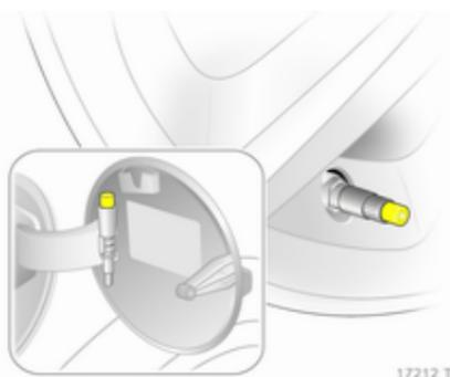
Bei Fahrzeugen mit Reifendruck-Kontrollsystem: Adapter auf Ventil schrauben.
