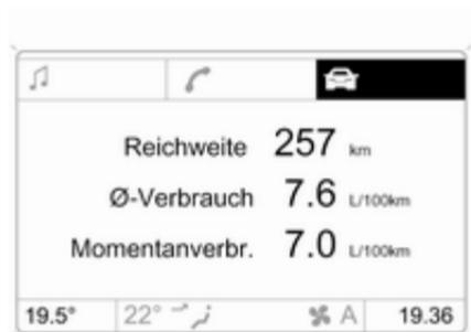
Die Reichweite wird aus dem momentanen Tankinhalt und dem Momentanverbrauch errechnet. Die Anzeige erfolgt mit gemittelten Werten.
