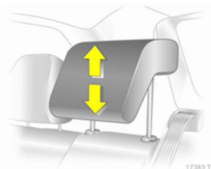
Kopfstütze nach oben ziehen bzw. die Rastfedern durch Drücken entriegeln und die Kopfstütze nach unten schieben.
