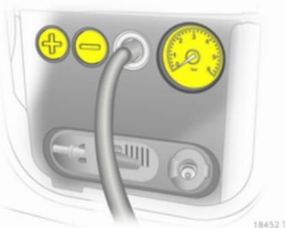
9. Kompressor durch Drücken der Taste **+** einschalten. Der Reifen wird mit dem Dichtmittel gefüllt.
