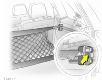
An den Seitenwänden befinden sich Befestigungsleisten zum Anbringen verschiedener Komponenten zur Unterteilung des Laderaums oder zur Befestigung der Ladung.
