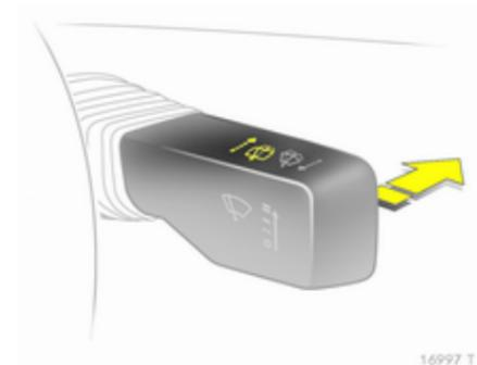
Hebel nach vorn drücken. Der Heck-scheibenwischer wischt im Intervallbetrieb. Zum Ausschalten Hebel nochmals nach vorn drücken.
