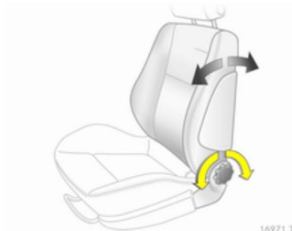
Handrad drehen. Zum Einstellen Rückenlehne entlasten.
