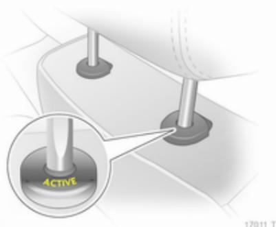
Bei einem Heckaufprall kippen die aktiven Kopfstützen etwas nach vorn. Der Kopf wird dadurch von der Kopfstütze besser abgestützt und die Gefahr von Verletzungen im Halswirbelbereich vermindert.
