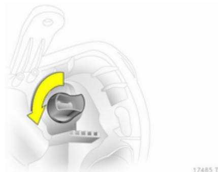
2. Lampenträger links herumdrehen und ausrasten.
