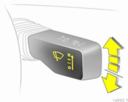
Der Hebel kehrt immer in die Ausgangsposition zurück.
