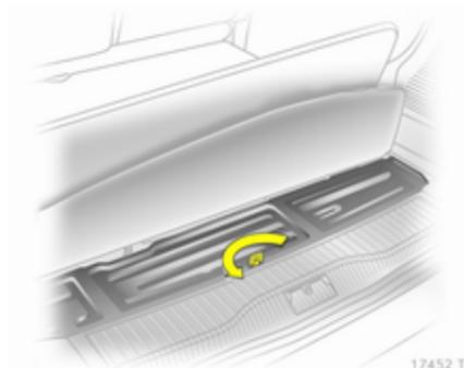
Zum Öffnen der Abdeckung Teppichboden anheben. Lasche hochstellen, drehen und hochziehen.
