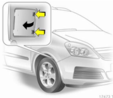
Der Lampenwechsel der vorderen äußeren Leuchten wird durch Öffnungen in den vorderen Radkästen
