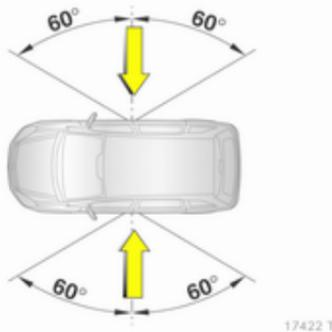
Das Seiten-Airbag-System löst bei einem Aufprall im gezeigten Wirkungsbereich ab einer bestimmten Unfallschwere aus. Die Zündung muss eingeschaltet sein.
