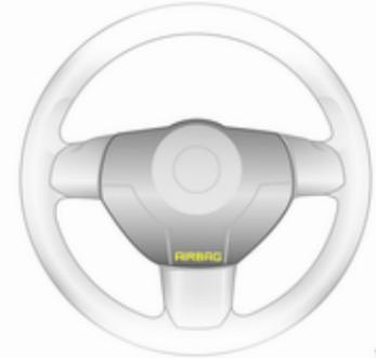
Das Front-Airbag-System besteht aus einem Airbag im Lenkrad und einem in der Instrumententafel. Diese Stellen sind mit dem Wort **AIRBAG** gekennzeichnet.
