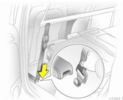
Haken der Netzspanngurte in Schlitz einhängen und spannen.
