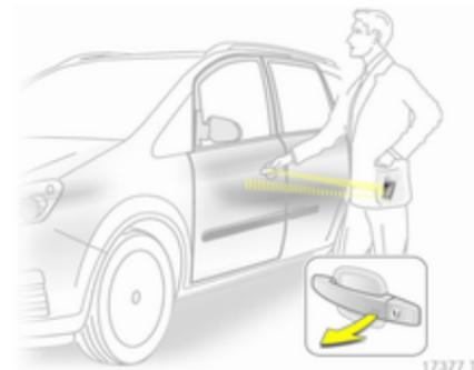
Bei Verwendung des elektronischen Schlüssels kann das Fahrzeug durch einfaches Ziehen am Türgriff entriegelt und die Tür geöffnet werden. Zum Öffnen der Hecktür Taste unter der Leiste drücken.
