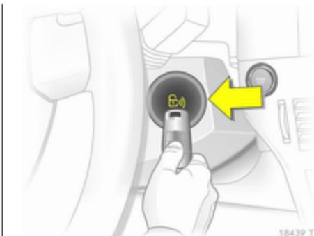
Elektronischen Schlüssel an die markierte Stelle halten und Taste **Start/Stop** drücken.
