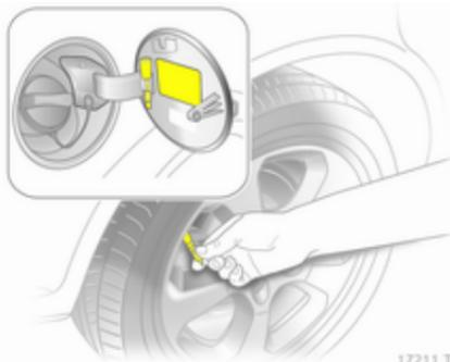
Ventilkappenschlüssel aus Tankklappe entnehmen und damit Ventilkappe abschrauben.
