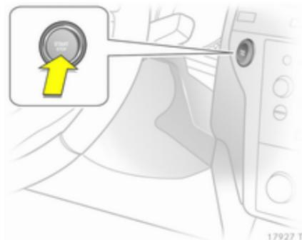
Der elektronische Schlüssel muss sich im Fahrzeug befinden. Kupplung und Bremse betätigen, Automatikgetriebe in Stellung **P** oder **N**.
