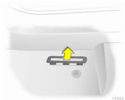
Die Fahrzeug-Identifizierungsnummer ist in das Typschild und das Bodenblech unter der Bodenabdeckung, zu sehen unter einer Abdeckung, eingestanz.
