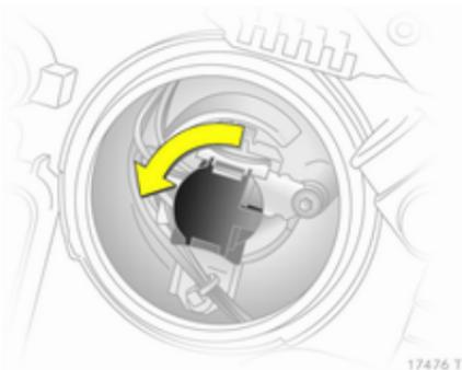
3. Lampenträger links herumdrehen und ausrasten. Lampenträger aus dem Reflektor ziehen.
