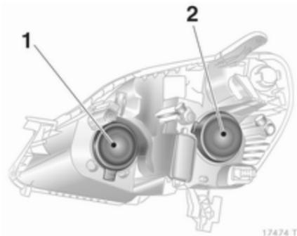
Scheinwerfer haben getrennte Systeme für Fernlicht **1** (innere Lampen) und Abblendlicht **2** (äußere Lampen).
