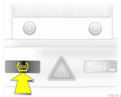
Nach einem Radwechsel muss das System initialisiert werden: Reifen mit dem vorgeschriebenen Reifendruck füllen, Zündung einschalten, Taste **DDS** für ca. 4 Sekunden drücken, Kontrollleuchte (D) blinkt dreimal.
