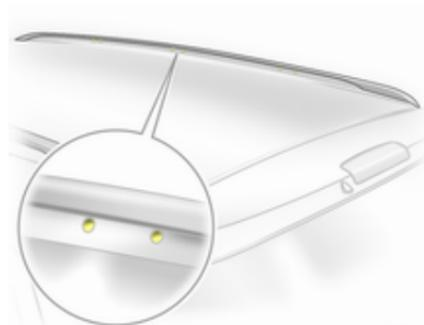
Zur Befestigung des Dachgepäckträgers Montagebolzen in die abgebildeten Bohrungen stecken.
