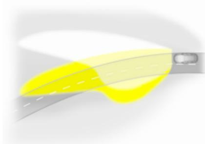
Der Lichtstrahl schwenkt in Abhängigkeit von der Lenkradstellung und der Geschwindigkeit.
