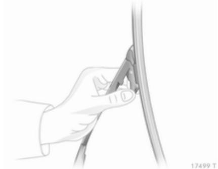
Wischerarm anheben, beide Riegel am Wischerarm drücken, Wischerblatt ausrasten und abziehen.
