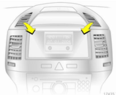
Lamellen öffnen und Richtung des Luftstroms einstellen.
