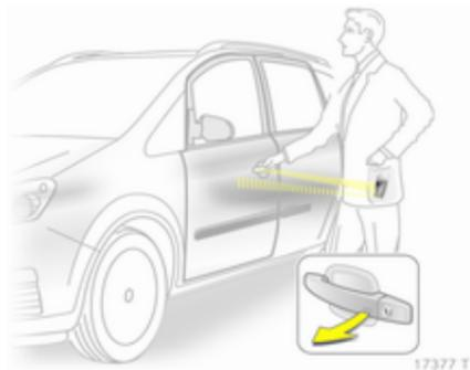
Ermöglicht die Betätigung folgender Funktionen ohne mechanischen Schlüssel:
