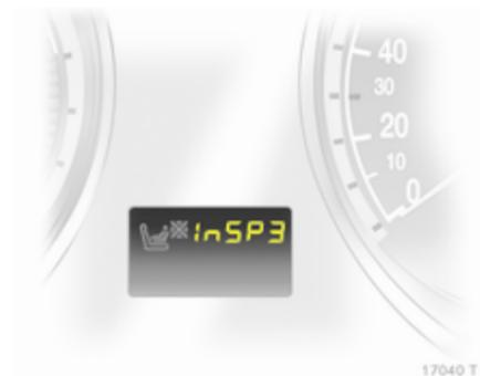
Die Batterie wechseln, sobald das System nicht mehr ordnungsgemäß funktioniert oder sich die Reichweite verringert. Batteriewechsel wird durch **InSP3** in der Serviceanzeige oder durch eine Check-Control Meldung im Info-Display angezeigt ↷ 102.
