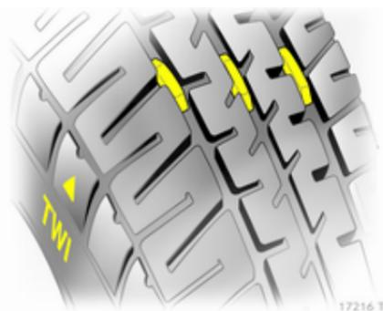
Die gesetzlich zulässige Mindestprofiltiefe (1,6 mm) ist erreicht, wenn das Profil bis zu einem Verschleißanzeiger (TWI = Tread Wear Indicator) abgefahren ist. Die Lage der Verschleißanzeiger wird durch Markierungen an der Reifenflanke angezeigt.
