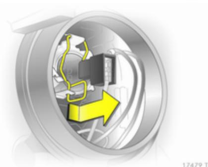
4. Federdrahtbügel nach vorn aus den Haltenasen ausrasten und nach unten schwenken.
