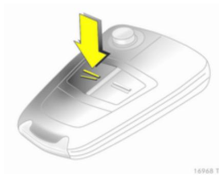
Zum Entriegeln und Öffnen der Tür Taste
