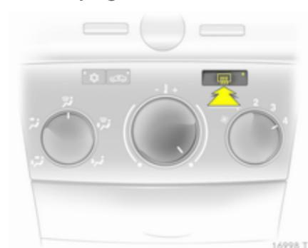
Die Heizung wird durch Drücken der Taste
