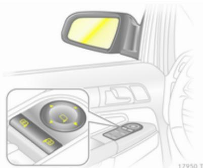
Zuerst entsprechenden Außenspiegel wählen, dann durch Schwenken des Schalters einstellen.
