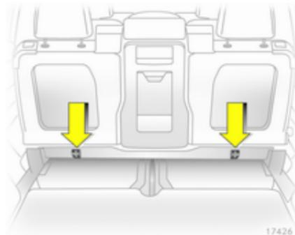
Top-Tether Kindersicherheitssystem an den Befestigungsösen der zweiten Sitzreihe befestigen. Der Gurt muss zwischen den beiden Führungsstangen der Kopfstütze verlaufen.
