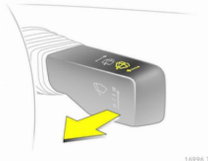
Hebel ziehen. Waschflüssigkeit spritzt auf die Windschutzscheibe und die Wischer werden für einige Wischbewegungen eingeschaltet.
