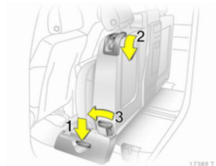
Entriegelungshebel **1** nach unten drücken und Sitzpolster bis zum Einrasten nach oben schwenken.
