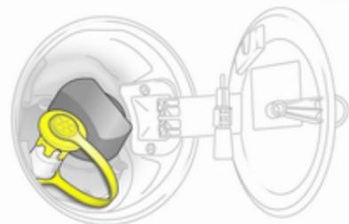
Beim Tanken von Erdgas Schutzkappe des Einfüllstutzens abziehen.
