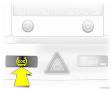
Nach Korrektur des Reifendrucks oder nach einem Radwechsel muss das System initialisiert werden: Zündung einschalten, Taste **DDS** für ca. 4 Sekunden drücken, Kontrollleuchte (⚠) blinkt dreimal.
