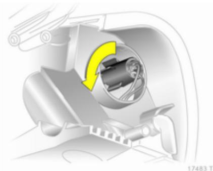
3. Lampenträger links herumdrehen und ausrasten.
