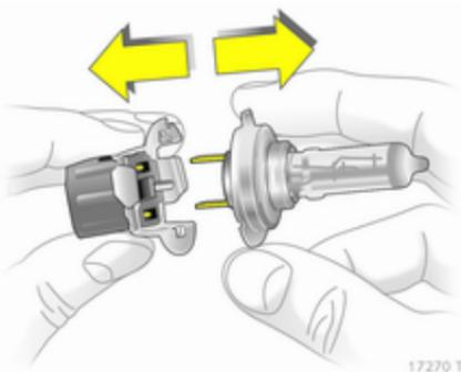
4. Glühlampe aus dem Lampenträger ziehen und neue Glühlampe einsetzen.
