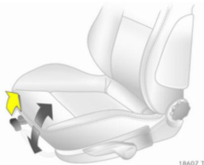
Hebel ziehen, Neigung einstellen durch Verlagerung des Körpergewichts. Hebel loslassen, Sitz hörbar einrasten.
