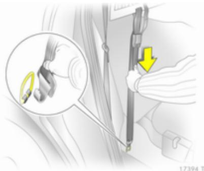
Haken der Netzspanngurte in die Ver-zurrösen am Boden einhängen und spannen.
