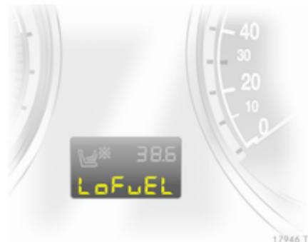
Bei Erdgasbetrieb und geringem Füllstand im Benzintank erscheint die Meldung **LoFuEL**. Die Meldung durch Drücken des Stellknopfs bestätigen  $\diamond$  85.
