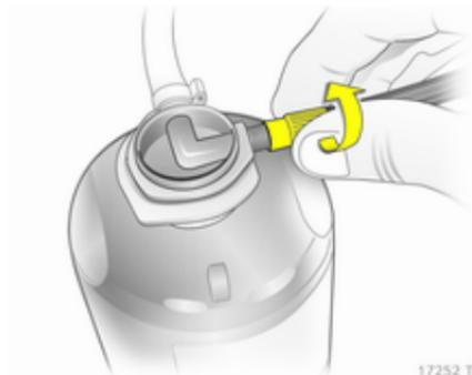
2. Luftschlauch vom Halter abwickeln und an den Anschluss der Dichtmittelflasche schrauben.
