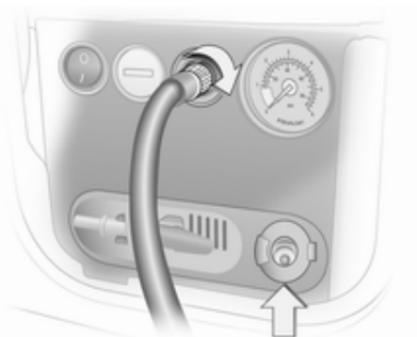
6. Luftschlauch an den Anschluss am Kompressor schrauben.
