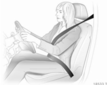
Sicherheitsgurt herausziehen und im Gurtschloss einrasten. Der Sicherheitsgurt muss unverdreht und eng am Körper anliegen. Die Rückenlehne darf nicht zu weit nach hinten geneigt sein (maximal ca. 25°).
